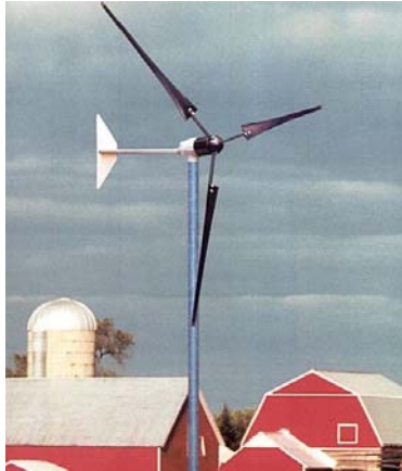
Εικόνα 8. Τρίπτερες ανεμογεννήτριες με πτερύγια προσανατολισμού.
