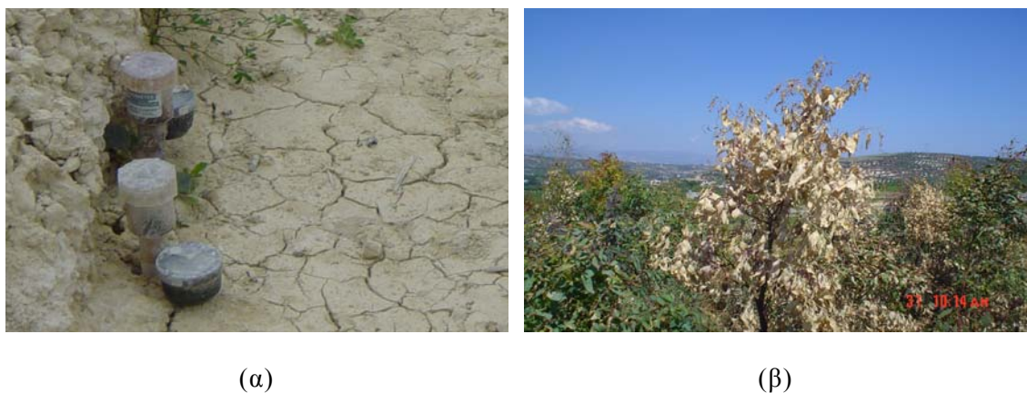
Εικόνα 4.4. (α) Τενσιόμετρα που τοποθετήθηκαν σε βάθος 30 εκατ. και 60 εκατ. και (β) ένα νεκρό δέντρο λόγω της επίδρασης τοξικότητας εμφανίστηκαν από τα υγρά απόβλητα ελαιοτριβείων κατά την εφαρμογή.
