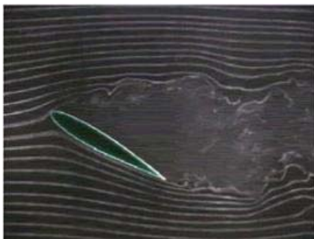
Σχήμα 3.8 Αποκόλληση ροής σε αεροτομή
