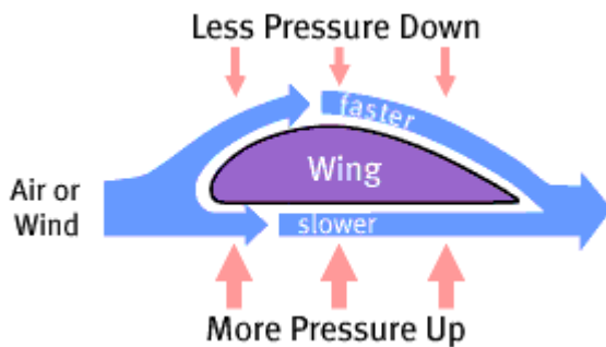
Σχήμα 3.4 Ταχύτητες ροής στην άνω και κάτω επιφάνεια αεροτομής
