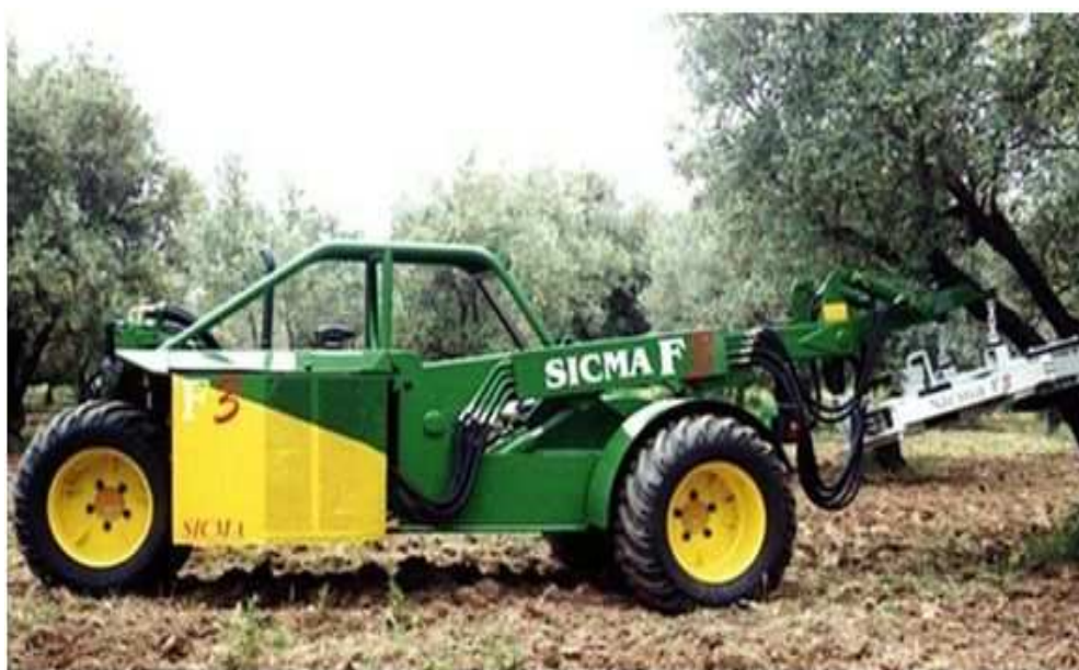
Εικόνα 41. Συγκομιδή ελαιοκάρπου με χρήση δονητή κορμού.
