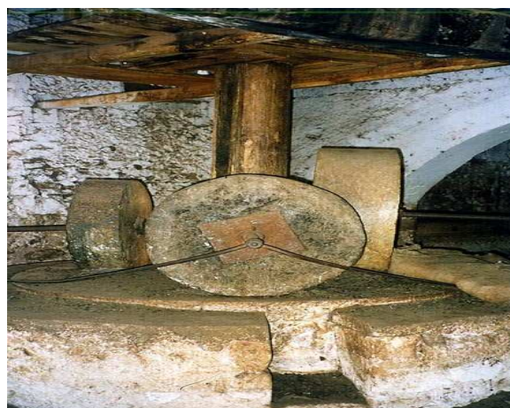
Εικόνα 33. Ελαιόμυλος με τρεις μυλόπετρες (Μετόχι Κουμαρές Χανίων. Ο πολιτισμός της ελιάς στη Κρήτη ΣΕΔΗΚ)
