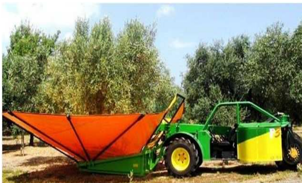
Εικόνα 40. Συγκομιδή ελαιοκάρπου με χρήση δονητή κορμού.
