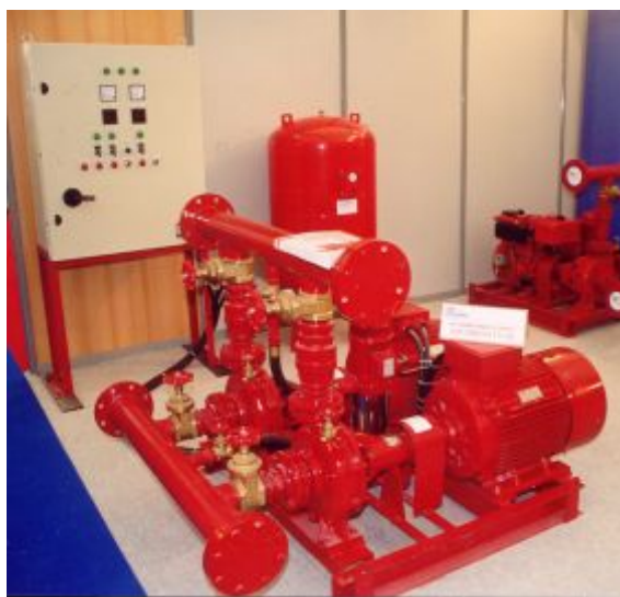
Εικόνα 26: Σύστημα φυγοκεντρικής αντλίας.
