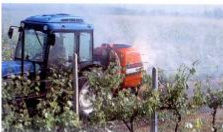
Εικόνα 24: Νεφελοψεκαστήρες κατά τη διάρκεια της εργασίας τους.
