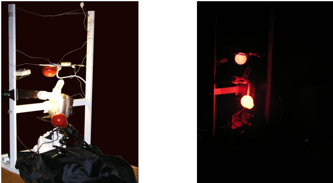
Εικόνα 14 :Αριστερά : Οι λευκές λάμπες ανάβουν κατά τη διάρκεια της φωτοφάσης. Δεξιά: Οι κόκκινοι λαμπτήρες ανάβουν κατά τη διάρκεια της σκοτοφάσης.
