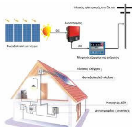
Εικόνα 4 : Οικιακό Φ/Β Σύστημα
