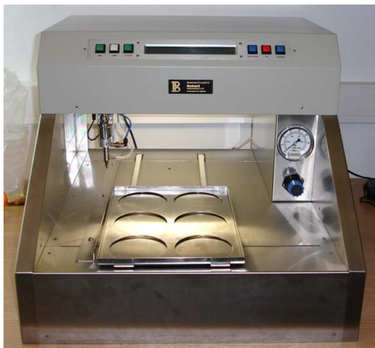
Εικόνα 24: Το μηχάνημα Burkard με 6θέσιο μεταλλικό δίσκο ψεκασμού
