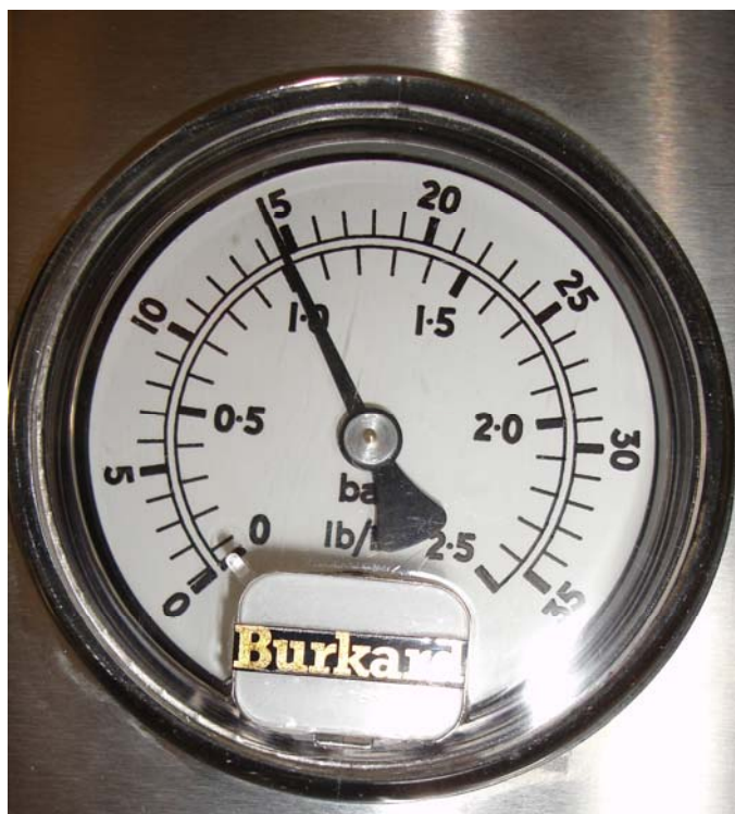
Εικόνα 27: ένδειξη ενσωματωμένου μανόμετρου στο Burkard 15 ατμόσφαιρες
