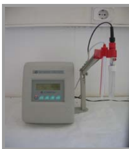
Εικόνα 4.9 (PH METER GLP 21, Crison)
