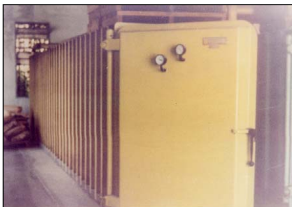
Εικ. 36 Θάλαμος κενού για απεντόμωση με βρωμιούχο μεθύλιο
