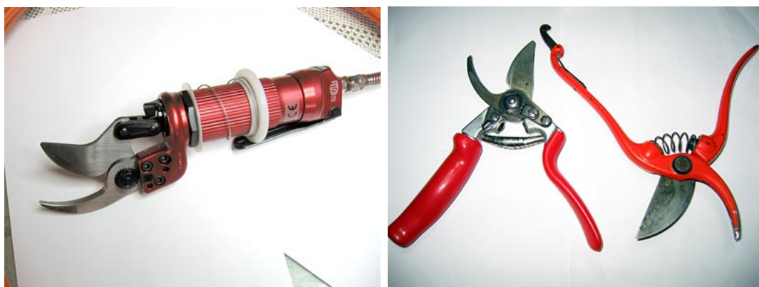
Εικόνα 18: α. αεροψάλιδο κλαδέματος, β. χειροψάλιδα κλαδέματος.
