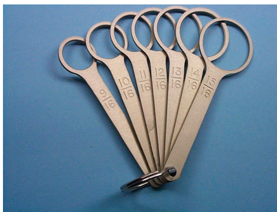
Εικόνα 25: Ειδικό εργαλείο που μετράει το μέγεθος των ραγών.
