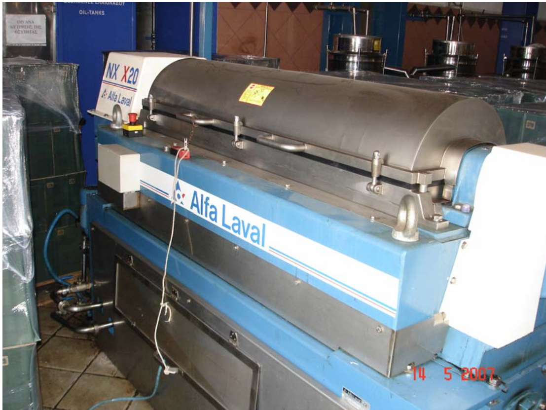
Εικ.3 Ο σύγχρονος φυγοκεντρητής (NTEKANTEP) δυο φάσεων.
