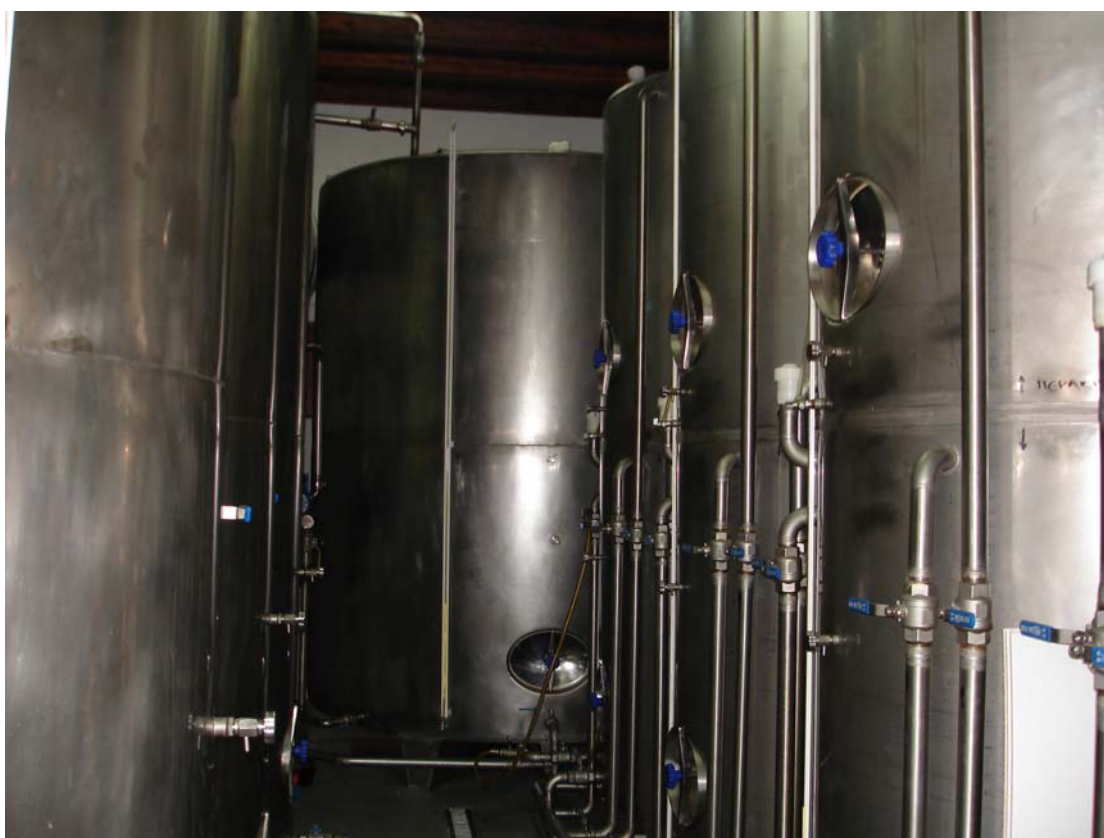
Εικ.5 Ανοξείδωτες δεξαμενές για την αποθήκευση του ελαιόλαδου χωριστά για κάθε βιοκαλιεργητή.
