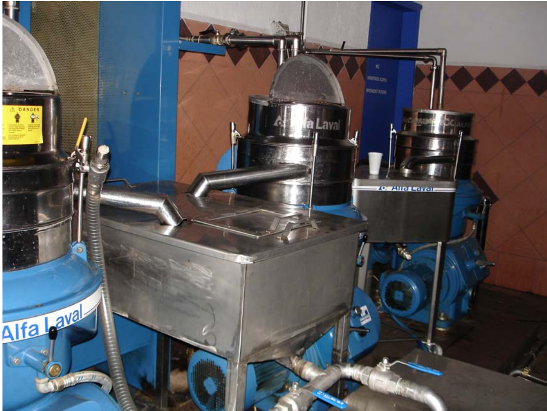
Εικ. 4 Οι ελαιοδιαχωριστήρες από το ελαιουργείο της "ΒΙΟΚΑΛΛΙΕΡΓΗΤΕΣ ΣΗΤΕΙΑΣ" ΑΕ
