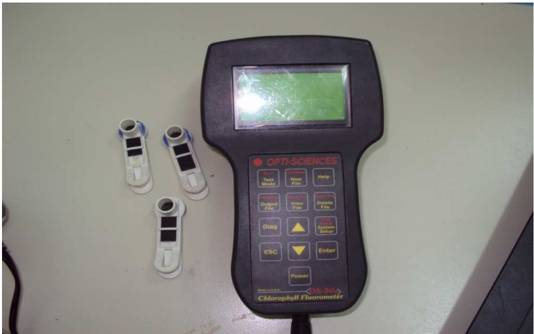
Εικόνα 4: Φθορίμετρο, opti-sciences OS-30p, UK και τα ειδικά 'μανταλάκια'.
