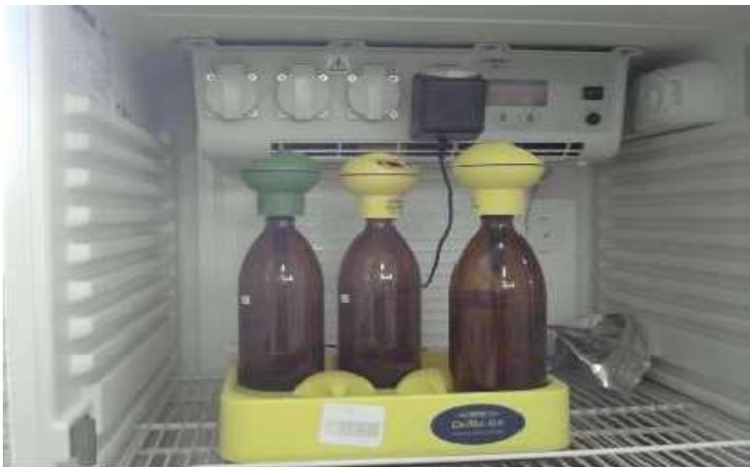
Εικόνα 9: Θάλαμος επώασης, μηχανισμός ανάδευσης και φιάλες με μανομετρικό μηχανισμό μέτρησης.
