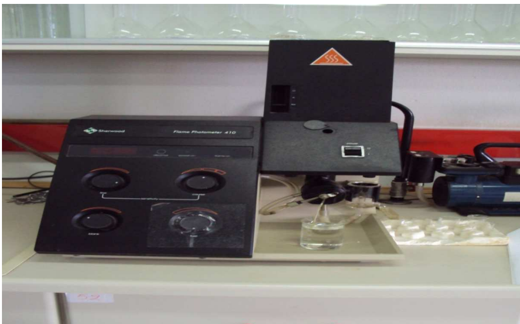
Εικόνα 13: Φλογοφωτόμετρο 410 της Shewood για τον προσδιορισμό καλίου και νατρίου.
