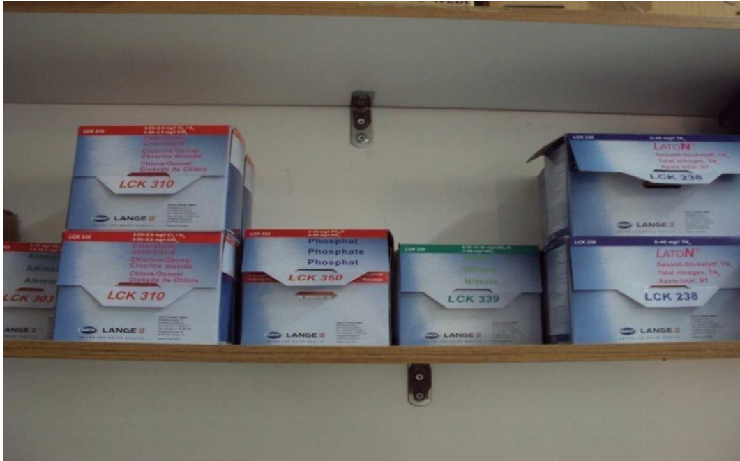
Εικόνα 12: Φωτομετρική μέθοδος με kit για την ανάλυση ολικού αζώτου, ολικού φωσφόρου, αμμωνιακών, νιτρικών και χλωρίου.
