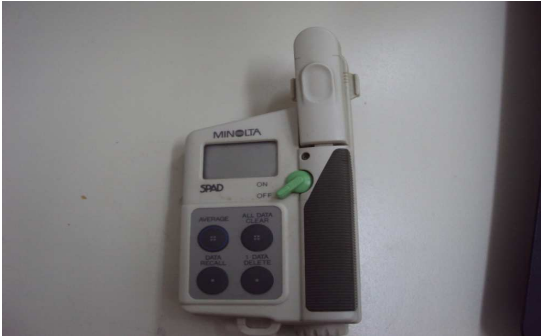
Εικόνα 3: Μέτρηση της χλωροφύλλης με το εξειδικευμένο όργανο Minolta SPAD.
