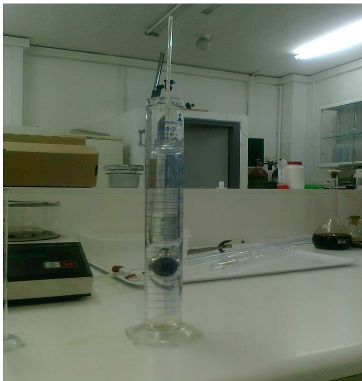
Εικόνα 32. Μέτρηση Αλκοολικού Βαθμού αποστάγματος πειραματικού οίνου.
