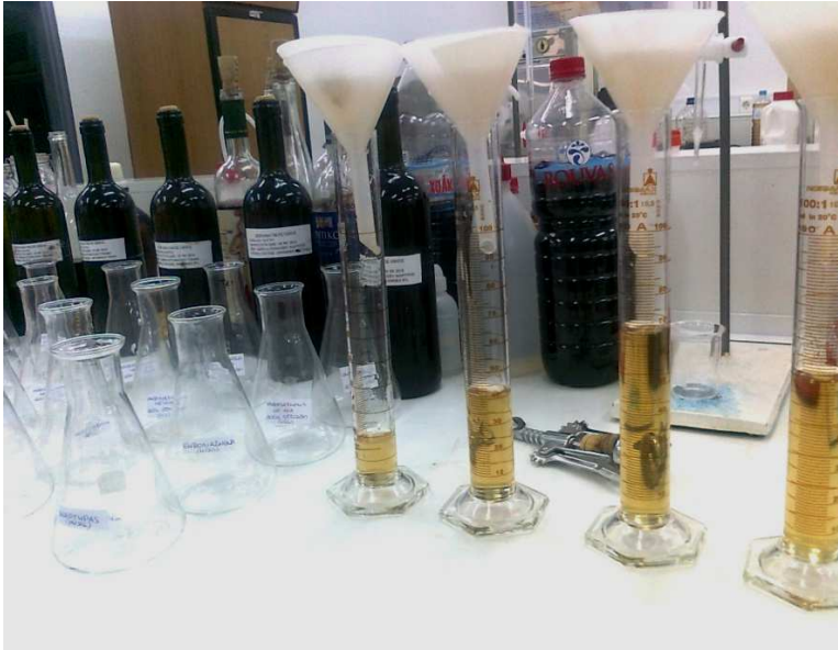
Εικόνα 34. Το φιλτράρισμα των πειραματικών οίνων
