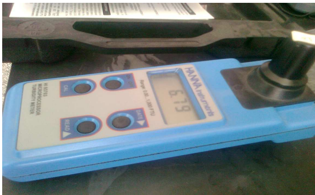
Εικόνα 29. Το φορητό φωτόμετρο, τύπου Hanna HI93703, εν ώρα μέτρηση δείγματος πειραματικού οίνου.
