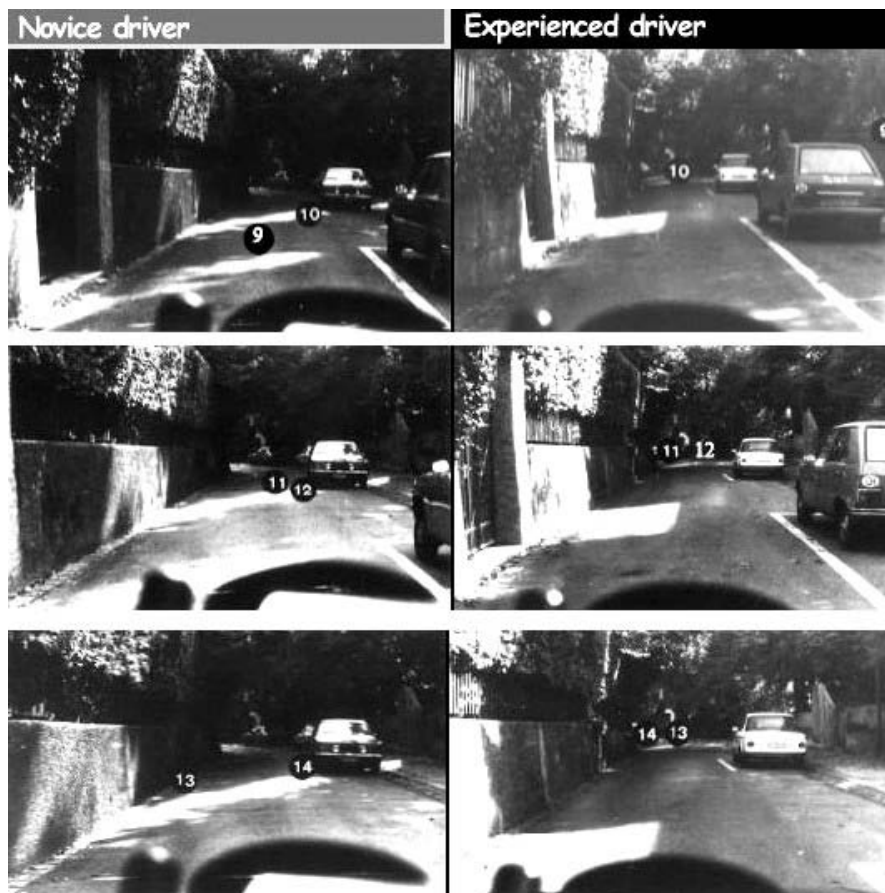
Εικόνα 13 Χρήση eye-tracking στην διαδικασία της οδήγησης
