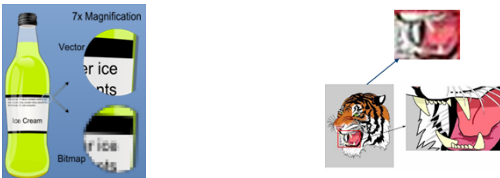
Εικόνα 2.31 Διαφορά εικόνων Bitmap και Vector (Adobe Systems Incorporated, 2008)
