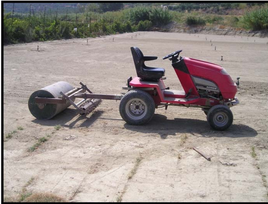
Εικόνα 1. Μηχάνημα για κυλίνδρισμα του εδάφους.
