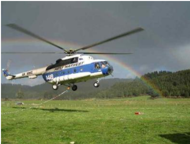
Εικόνα 16: Χρήση ελικοπτέρου για προστασία από τον παγετό.
