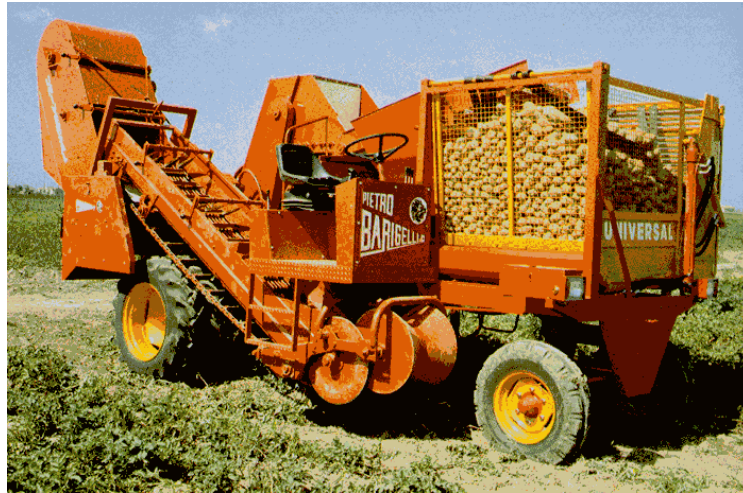
Εικόνα 18. αυτόματος συλλέκτης πατάτας
