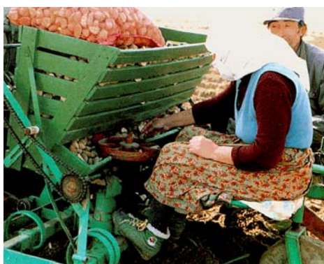
Εικόνα 7. μηχανή φυτέματος πατάτας
