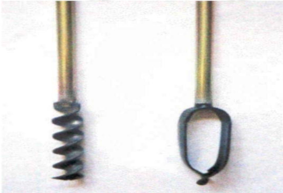
Εικόνα 2. Δειγματολήπτες τύπου α) Edelman (δεξιά) και β) σπειροειδής (αριστερά)
