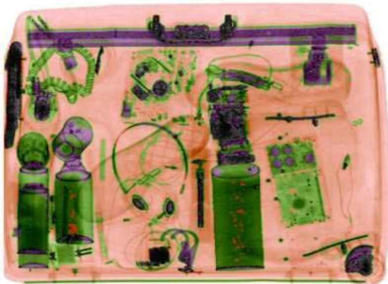
Η εικόνα μιας αποσκευής όπως φαίνεται όταν περνάει μέσα από συσκευή X-RAY. Παρατηρείστε ότι όλα τα οργανικά αντικείμενα έχουν χρώμα πορτοκαλί.
