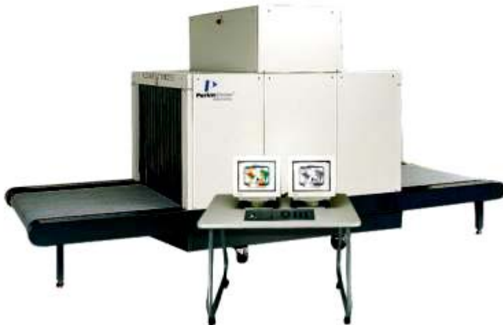
μηχάνημα X-RAY, χρησιμοποιείται για τον έλεγχο αποσκευών και χειραποσκευών.
