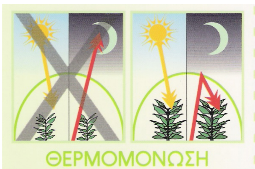
Εικόνα 16 : Τα ειδικά θερμικά φύλλα 3- στρώσεων προσφέρουν θερμομονωτικές ιδιότητες
