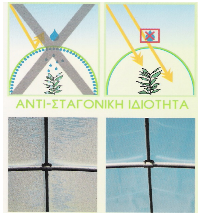
Εικόνα 18 : Φύλλα anti-fogging για την αποτροπή της δημιουργίας σταγόνων
