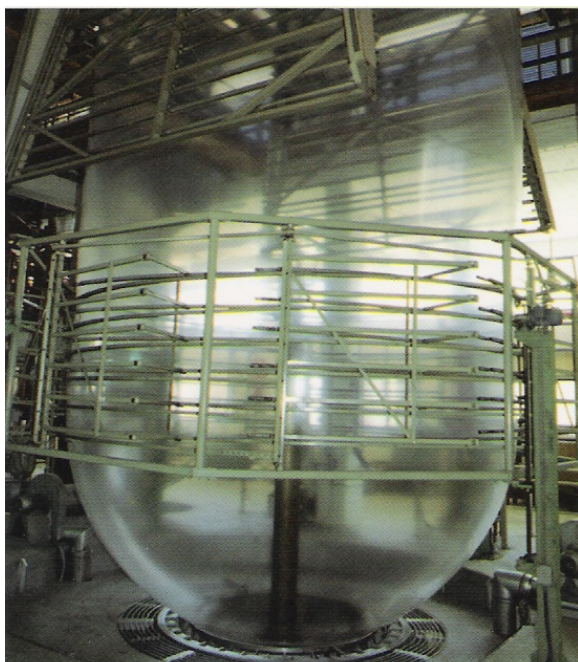
Εικόνα 11 : Παραγωγή φύλλων Πολυαιθυλενίου στο εργοστάσιο «Πλαστικά Κρήτης»
