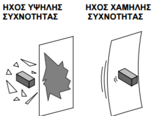
σχήμα 5.1.4. Ήχος υψηλής και χαμηλής συχνότητας του ανιχνευτή θραύσης κρυστάλλων.
