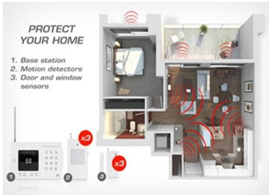
σχήμα 2.5.1. Συσκευές αισθητήρων που είναι τοποθετημένοι σε όλους τους χώρους του σπιτιού για την ενημέρωση της κατάστασης που βρίσκεται ο κάθε χώρος. Οι συσκευές ανιχνεύουν κίνηση μέσα στο χώρο αλλά και στις πόρτες ή στα παράθυρα
