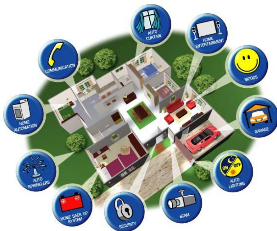
σχήμα 2.2. αυτοματοποιημένο σύστημα στο οποίο ο χρήστης ενημερώνεται για την κατάσταση στην οποία βρίσκεται το σπίτι όσον αφορά την ασφάλεια (μέσω κάμερας), τον αυτόματα ρυθμιζόμενο φωτισμό εντός και εκτός σπιτιού, αυτόματο πότισμα και άλλων λειτουργιών που διευκολύνουν τις ανάγκες του.
