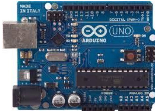
σχήμα 4.11.3. πλακέτα arduino η οποία έχει τη δυνατότητα σύνδεσης με υπολογιστή ώστε ο χρήστης να μπορεί να ενημερώνεται για την κατάσταση του αισθητήρα ανά πάσα στιγμή.
