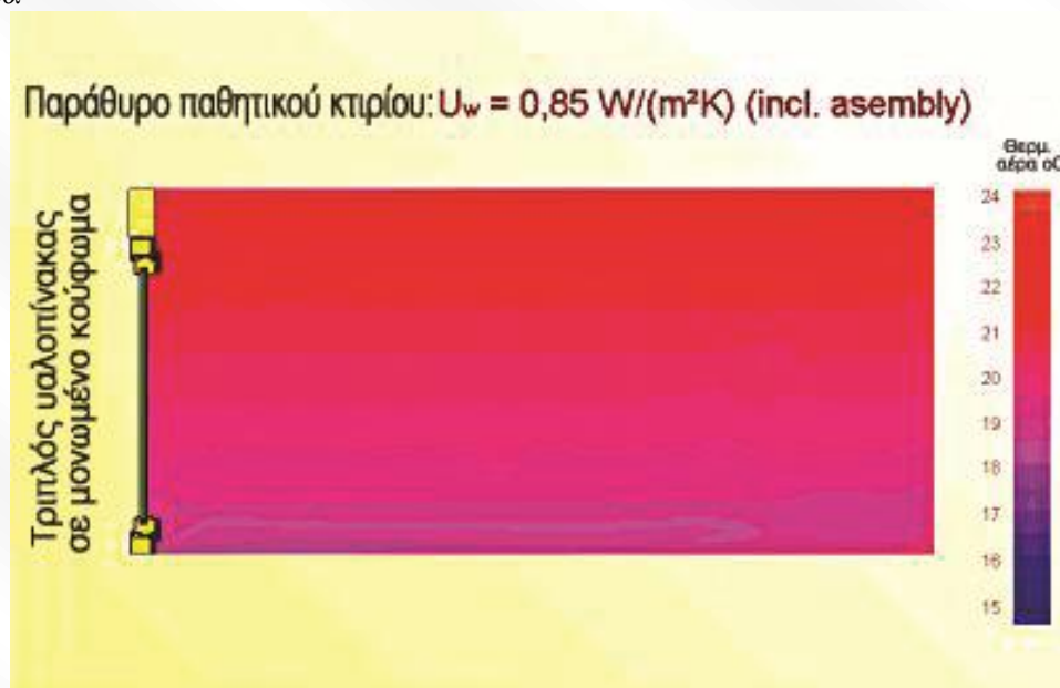
Διάγραμμα 6. Διαστρωμάτωση θερμοκρασίας μονωμένου κουφώματος με τριπλά τζάμια 19
