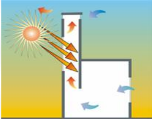
Εικόνα 10. Τρόπος λειτουργίας ηλιακής καμινάδας
