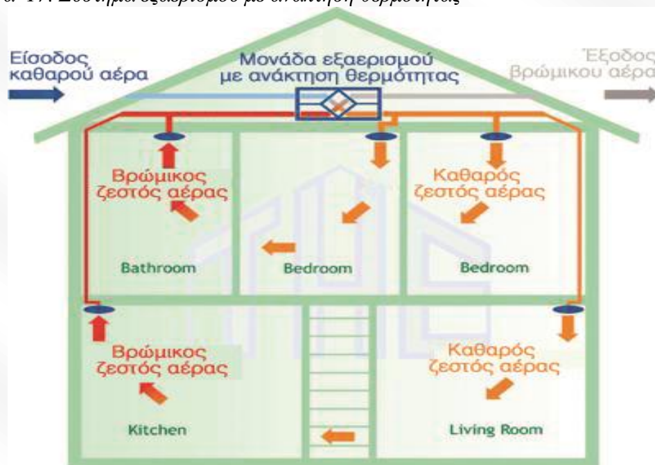
Εικόνα 17. Σύστημα εξαερισμού με ανάκτηση θερμότητας 38
