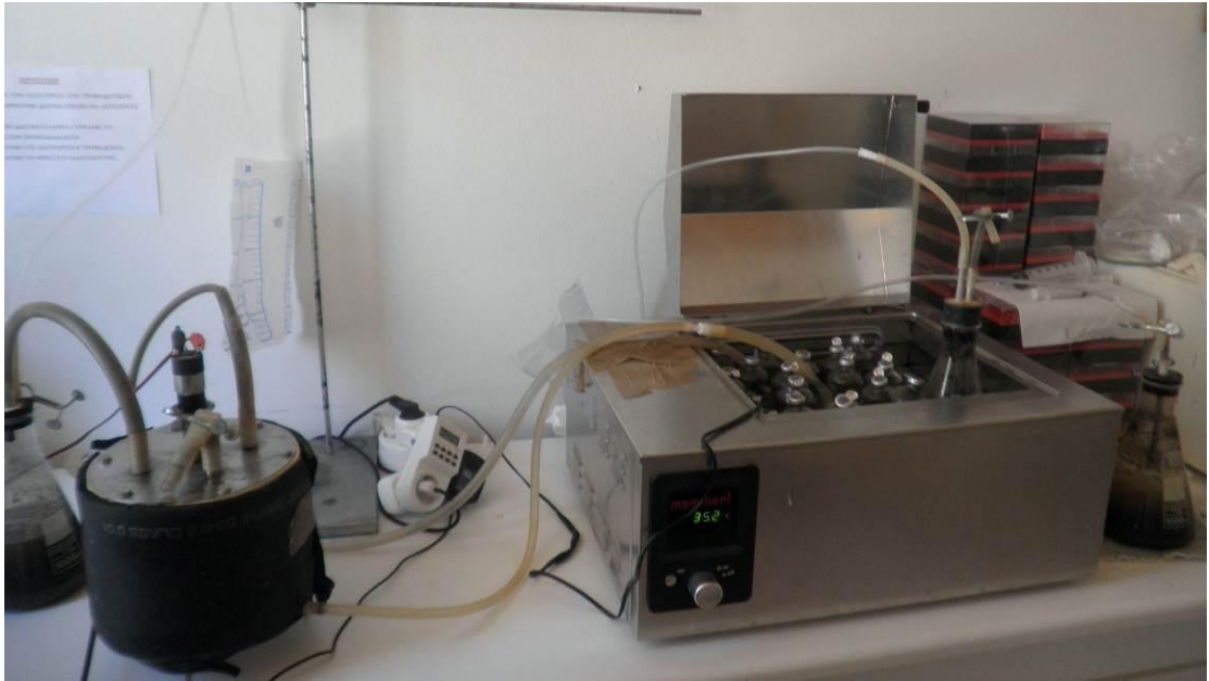
Εικόνα 5.4: Πειραματική διάταξη αναερόβιων αντιδραστήρων (αστική ιλύ, ΑΣΑ)
