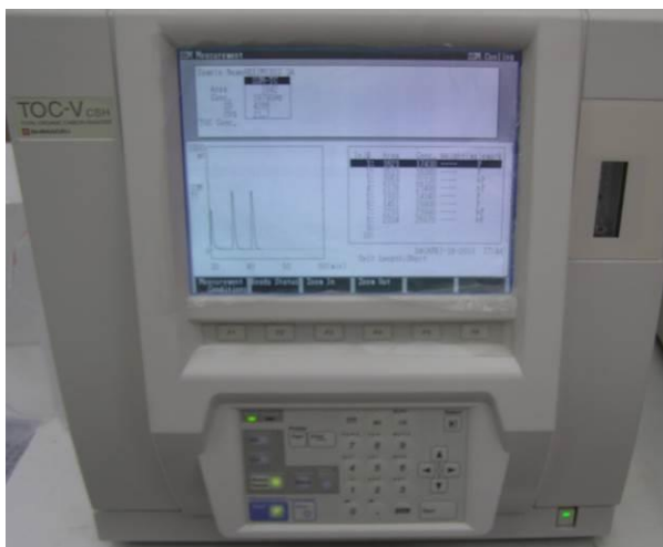
Εικόνα 4.11: Μηχάνημα προσδιορισμού ολικού οργανικού αζώτου (TOC).
