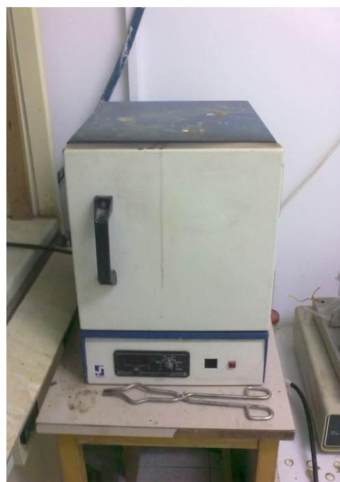
Εικόνα 4.9: Τοποθέτηση δειγμάτων στους 550°C για 2h.
