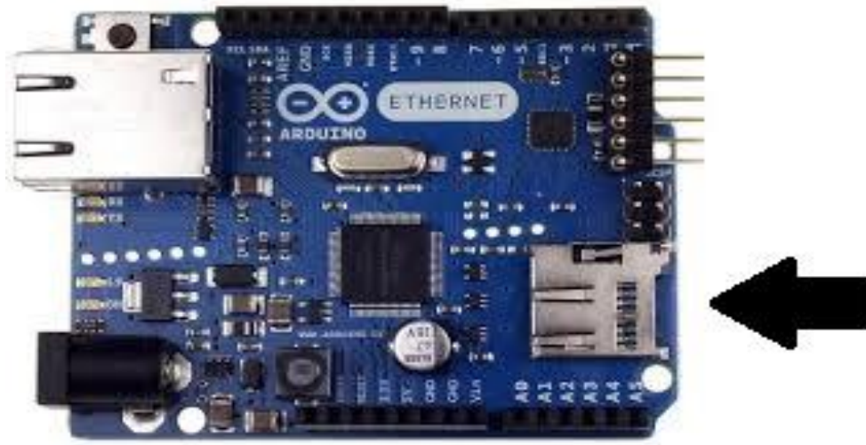
Εικόνα 12 – Ethernet Shield με Micro-SD Card Reader
