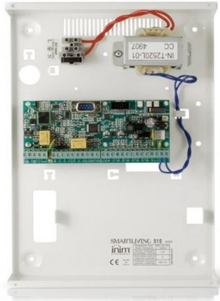
Εικόνα 4 Κεντρική πλακέτα Inim 515 Μαζί με το τροφοδοτικό της τοποθετημένα στο περίβλημα τους.
