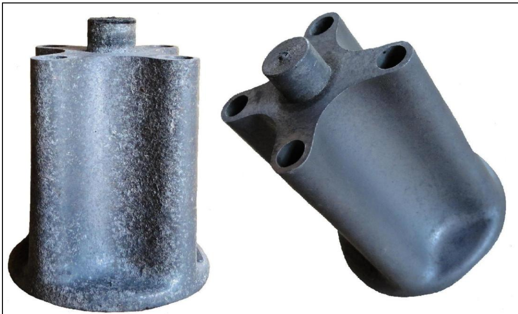
Εικόνα 9 Αλουμινένιο εξάρτημα προπέλας πριν και μετά την οξείδωση
