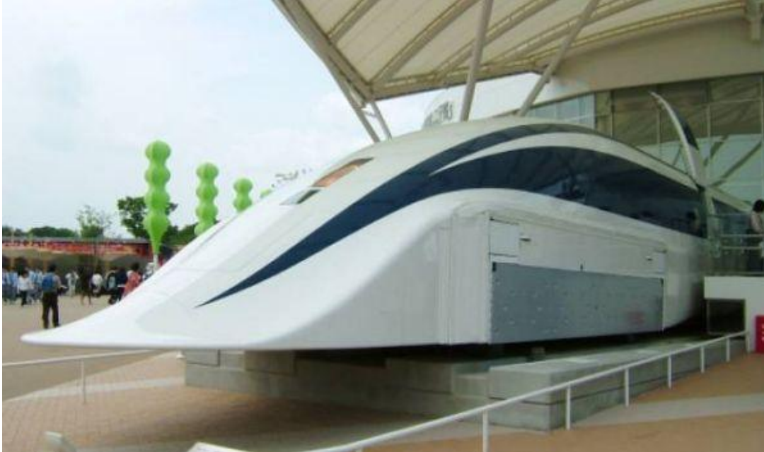
Εικόνα 45 Τα υπερσύγχρονα μαγνητικά τρένα υψηλών ταχυτήτων που είναι φτιαγμένα σε πλειοψηφία από αλουμίνιο
