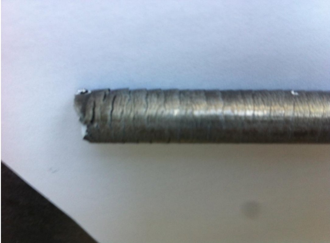
Εικόνα 65 Στην επιφάνεια των ίδιων δειγμάτων ύστερα από τα πειράματα εφελκυσμού παρουσιάστηκε το λεγόμενο φαινόμενο <<Κροκοδείλου>> όπου φαίνεται ξεκάθαρα ότι έχει παρουσιαστεί αστοχία του υλικού που επίσης προτρέπει στο ότι η χρήση υψηλότερης ποιότητας δειγμάτων
