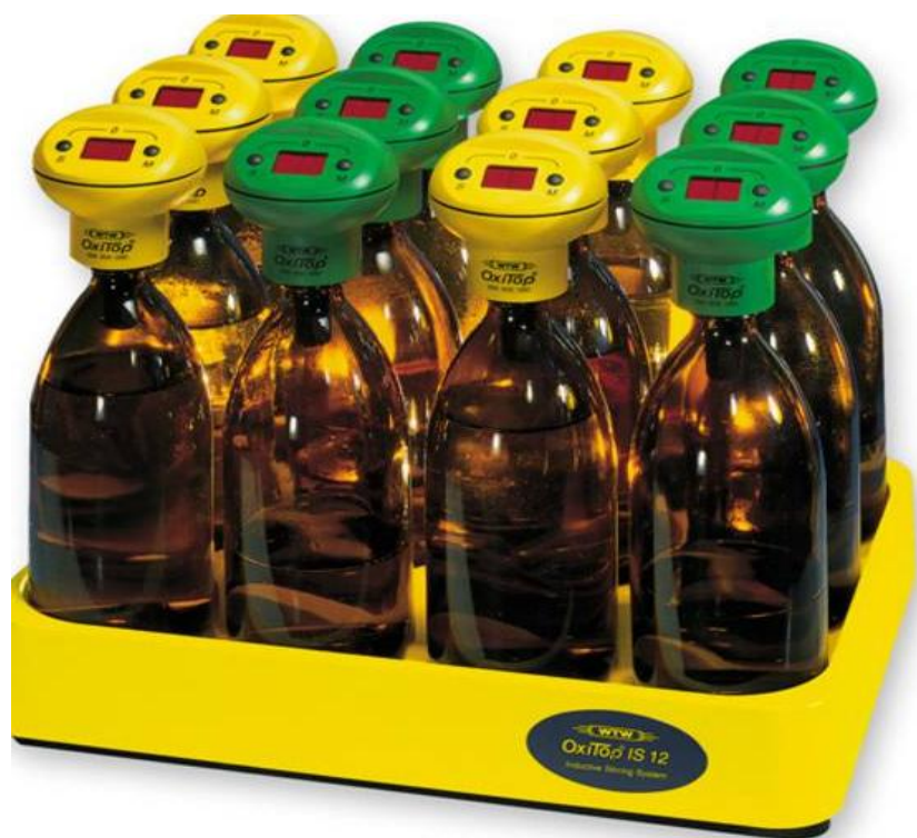
Εικόνα 15. Φιάλη και Συσκευή μέτρησης BOD (Oxitor S12,WTW)
