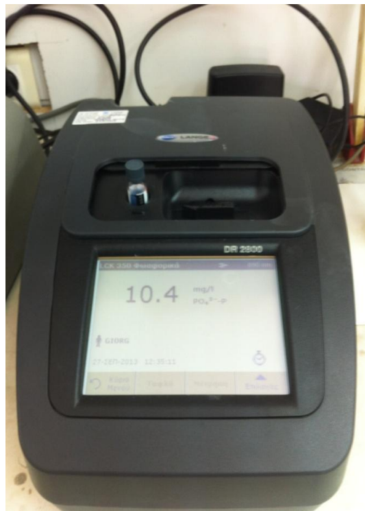
Εικόνα 12. Φασμαφωτόμετρο Hach Lange DR 280
