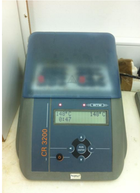
Εικόνα 13. Θερμικός Αντιδραστήρας WTW CR 3200
