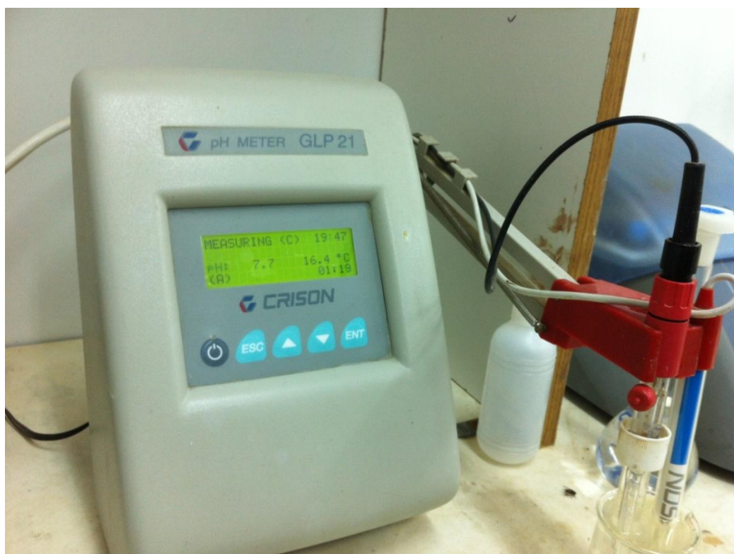
Εικόνα 5. Πεχάμετρο CRISON (pH Meter GLP21)
