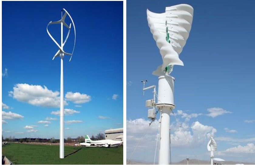
Γράφημα 30. (α) Ελικοειδής Α/Γ Quiet Revolution [Πηγή: http://www.zeroenergybuildings.org ]
