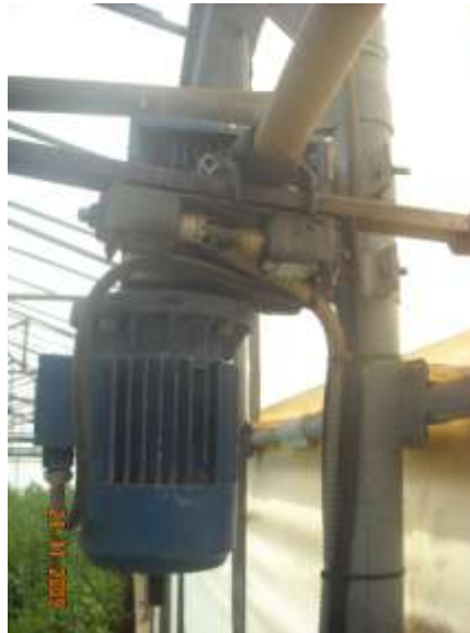
Εικόνα 32: Μειωτήρας ανοίγματος παραθύρων στα θερμοκήπια.
