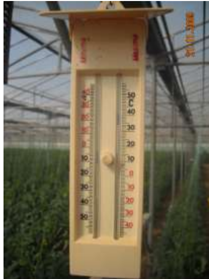
Εικόνα 19: Το θερμόμετρο που δείχνει την ελάχιστη (αριστερή στήλη) και τη μέγιστη (δεξιά στήλη) θερμοκρασία μέσα σε ένα θερμοκήπιο.
