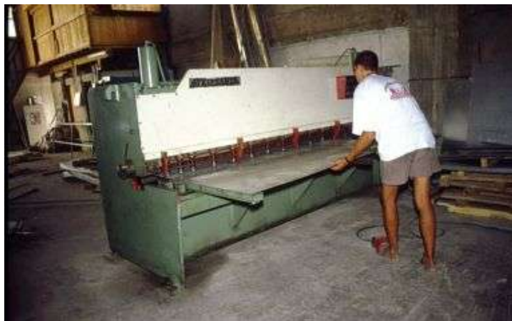
Εικόνα 33: Βιομηχανικός εξοπλισμός κατασκευής μεταλλικού θερμοκηπίου.
