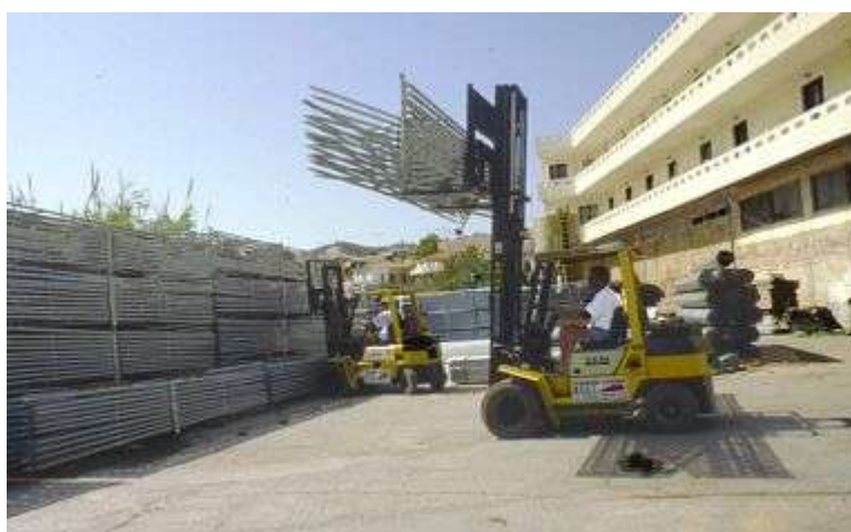
Εικόνα 34: Δεσμίδες μεταλλικών σκελετών θερμοκηπίου πάνω σε κλάρκ.
