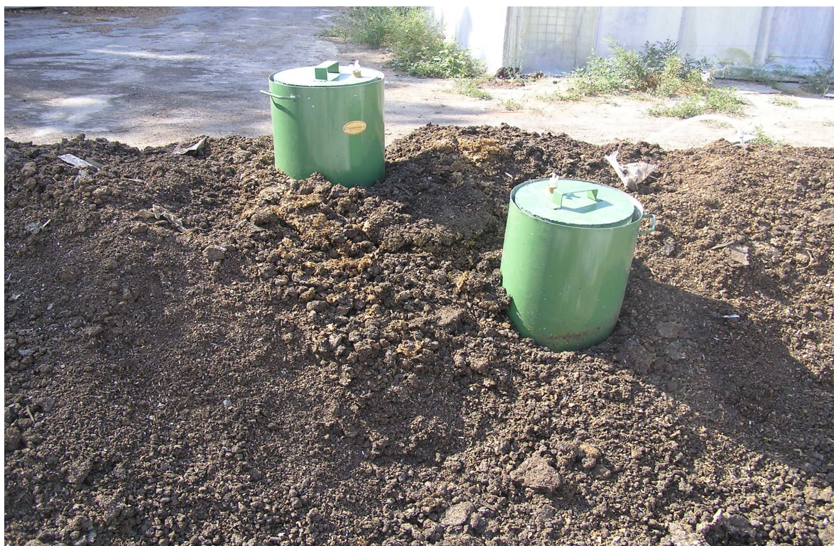
Εικόνα 2.7. Μέτρηση ροών με τη μέθοδο ‘static accumulation chamber’ με την εγκατάσταση των θυλακίων ‘chambers’ στην κορυφή και σε μια πλευρά του κάθε σωρού (συλλογή αέριων με σύριγγες των 60 ml).
