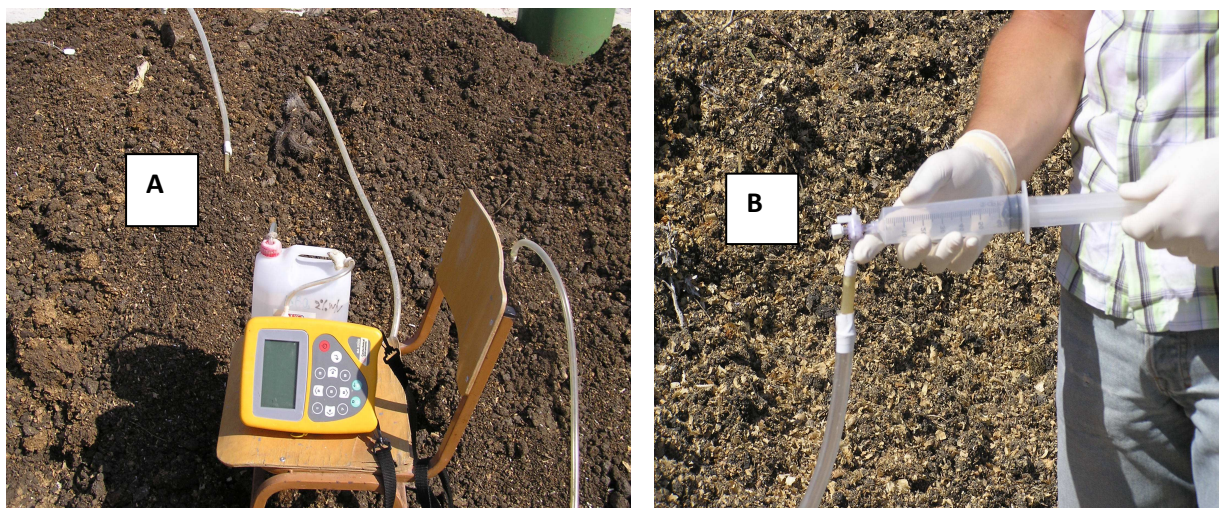
Εικόνα 2.5. Καθημερινή μέτρηση αερίων με τον αναλυτή αερίων Gas Analyser (A) και σύριγγες των 60ml, για προσδιορισμό της συγκέντρωσής των αερίων με την μέθοδο της αέριας χρωματογραφίας (GC ) (B).
