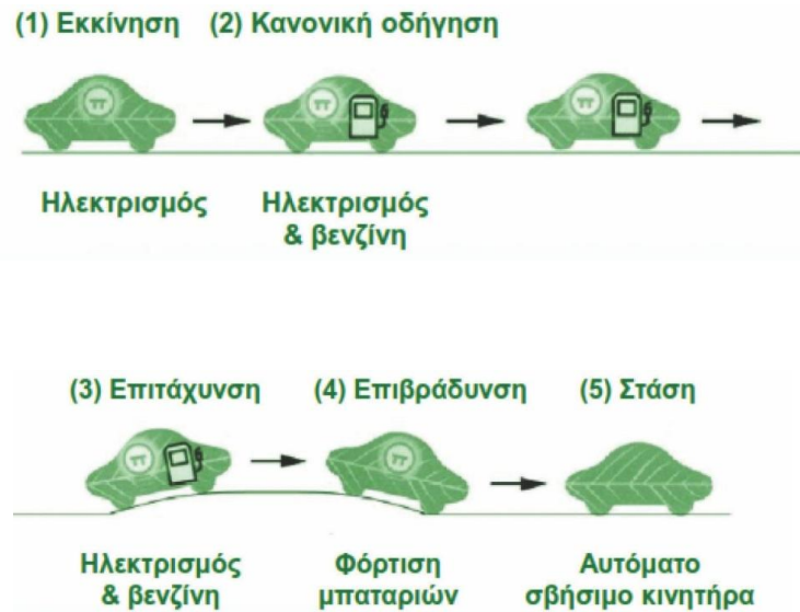
Σχήμα 5.42: Χαρακτηριστικά κίνησης Lexus RX 400.
