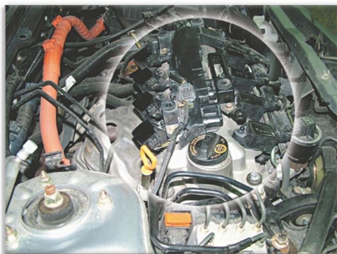
Εικόνα 5.4: Οκτώ μονάδες ανάφλεξης στον κινητήρα. Σύστημα μεταβλητού χρονισμού βαλβίδων βενζινοκινητήρα.
