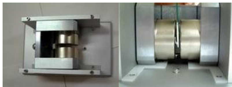
Εικόνα 3.26: Μόνιμος μαγνήτης 0.55 Tesla
