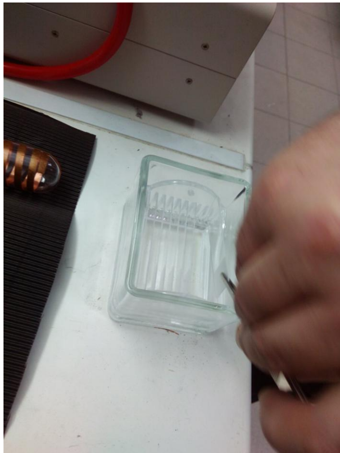
Εικόνα 6.4: Δοχείο τοποθέτησης υποθεμάτων
