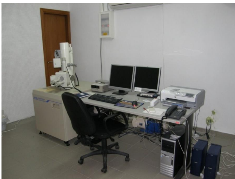
Εικόνα 3.11: Ηλεκτρονικό μικροσκόπιο σάρωσης (Scanning Electron Microscopy, S.E.M) Κέντρο Έρευνας Τεχνολογίας Υλικών και Φωτονικής, Κ.Ε.Τ.Υ.Φ. - Τ.Ε.Ι. Ηρακλείου
