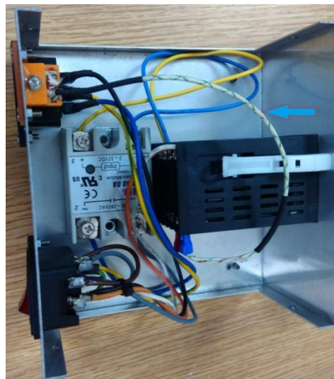
Εικόνα 5.22: Μικρό τεμάχιο με καλώδιο θερμοστοιχείου K
