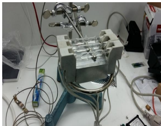
Εικόνα 5.7: Τοποθέτηση αισθητηρίου πολύ κοντά στις λάμπες
