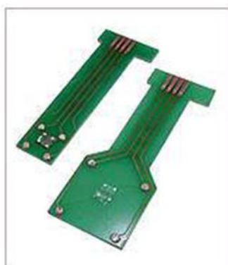
Εικόνα 3.21: PCB για συγκράτηση δείγματος (6mm x 6mm, 20mm x 20mm)
