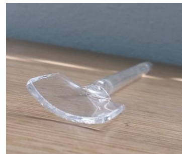
Εικόνα 5.13: Φτυάρι για εισαγωγή υποθέματος
