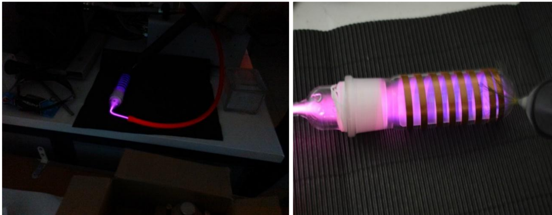
Εικόνα 6.3: Καθαρισμός με πλάσμα με τη χρήση ηλεκτροδίου
