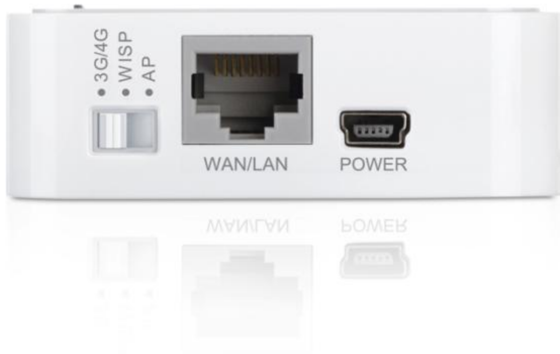
Σχήμα 5.2: Mode switch διακόπτης, υποδοχή Ethernet και υποδοχή τροφοδοσίας.
