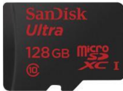
Σχήμα 2.5: MicroSD κάρτα, χωρητικότητας 128Gb , ταχύτητας Class 10
