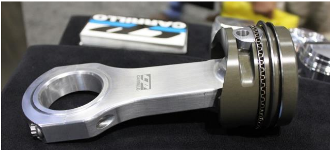
Εικόνα 11. Πιστόνι και μπιέλα κινητήρα κατασκευασμένα με κράματα βηρυλλίου..
