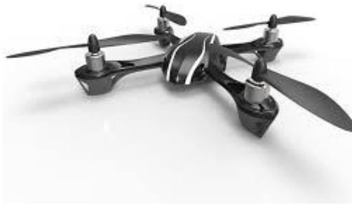
Εικόνα 1.2: τετρακόπτερο ρομποτικό σύστημα (Quadra Copter). [2]
