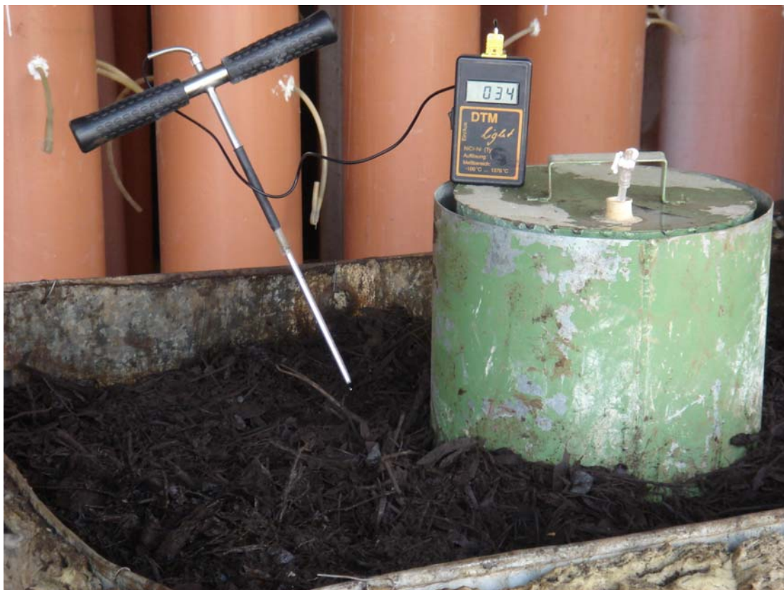
Εικόνα 8: Μέτρηση θερμοκρασίας σωρού
