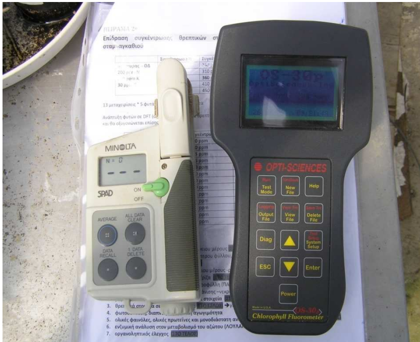
Εικόνα 3.11. Αριστερά το όργανο μέτρησης χλωροφύλλης Minolta, και δεξιά το όργανο μέτρησης φθορισμού opti-sciences.
