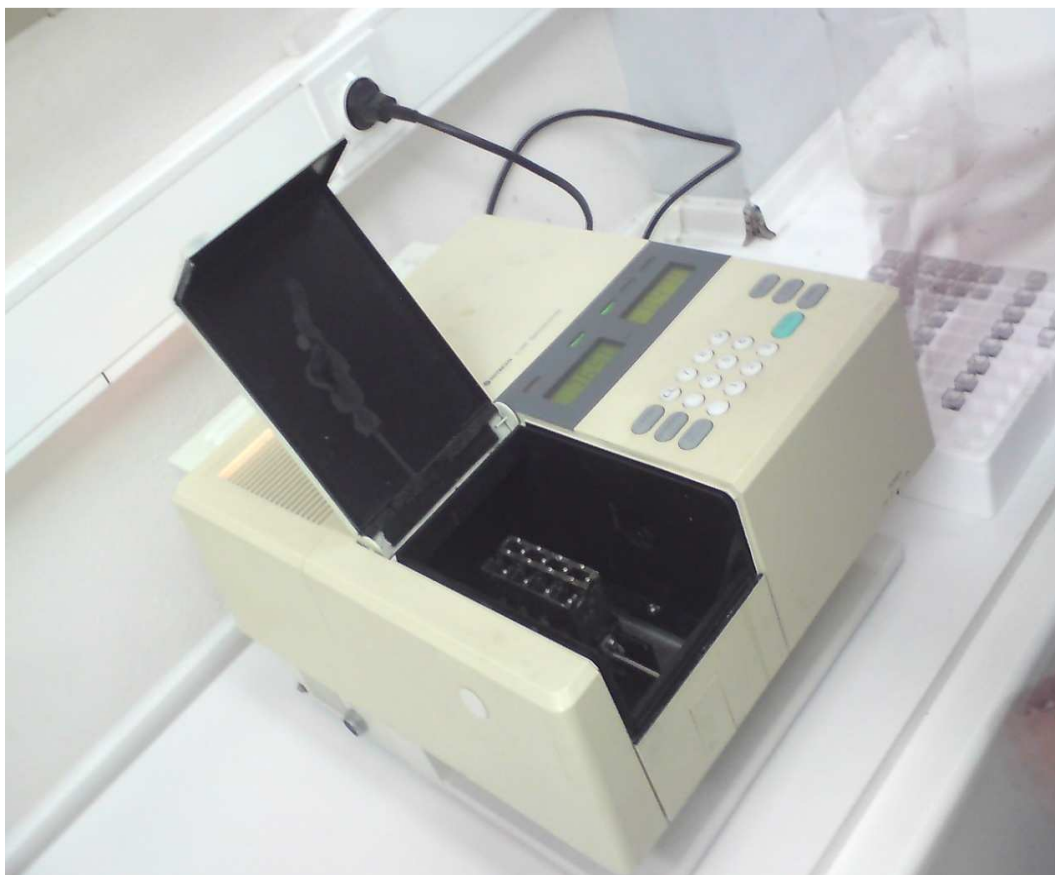
Εικόνα 3.14. Φασματοφωτόμετρο για τον προσδιορισμό της περιεκτικότητας σε ολικές φαινόλες.
