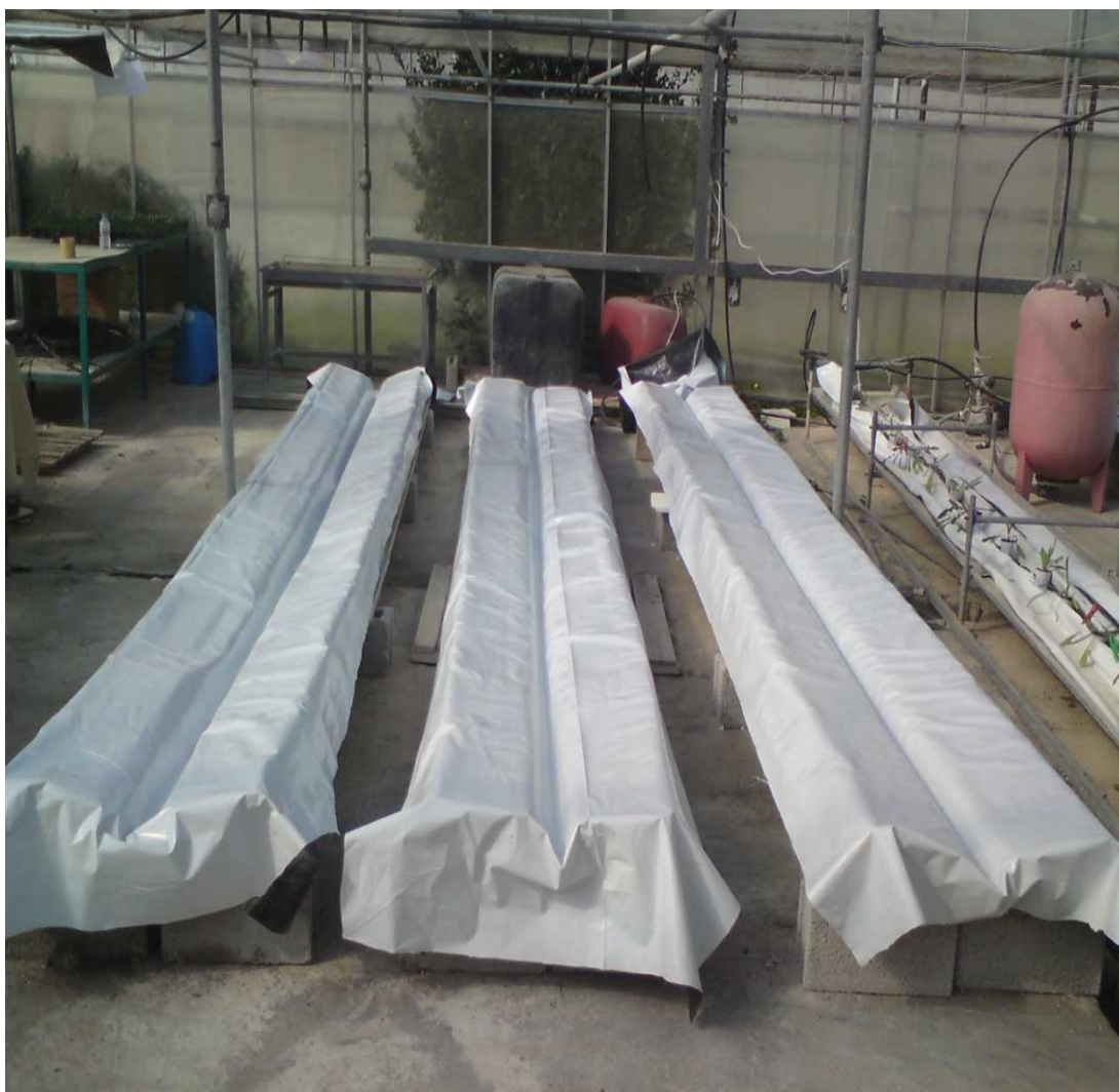
Εικόνα 3.3. Τρία ανεξάρτητα κανάλια ανάπτυξης φυτών για την εφαρμογή των τριών επιπέδων αλατότητας, με την επιθυμητή κατά μήκος κλίση.
