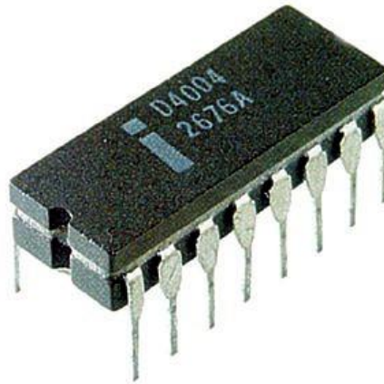
Εικόνα 5: Ο Intel 4004, ο πρώτος από τους μικροεπεξεργαστές που κατασκευάστηκαν. Χρονολογία παραγωγής: 1971 μέχρι 1981.
