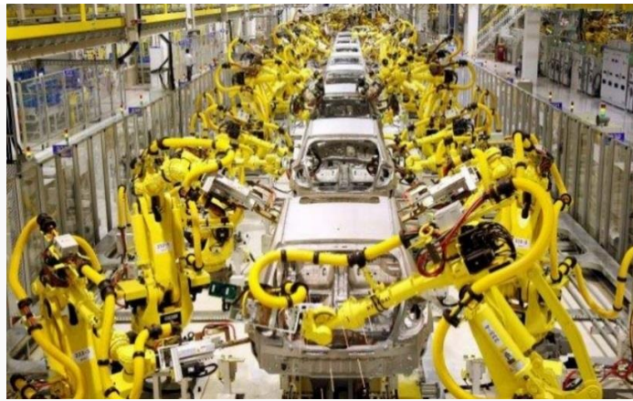
Εικόνα 4: Βιομηχανικά ρομπότ σε μία αυτοματοποιημένη μονάδα παραγωγής αυτοκινήτων
