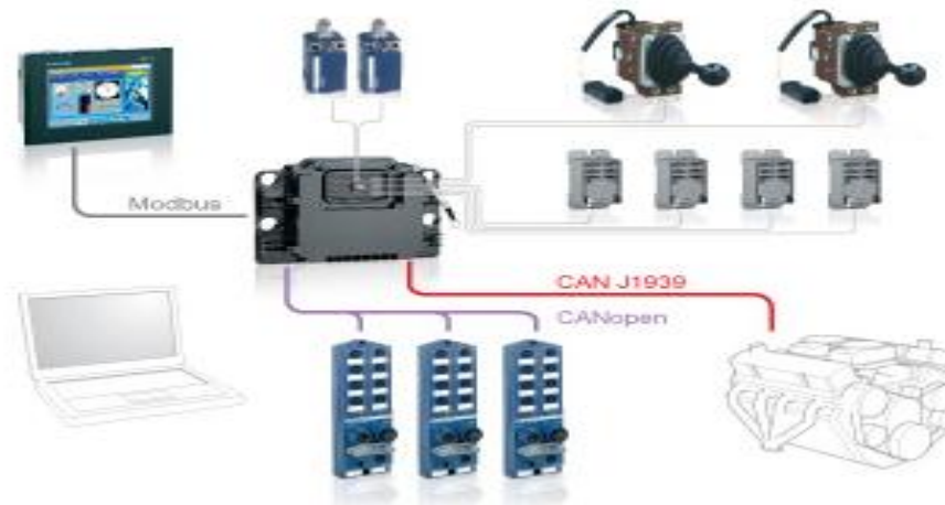
Εικόνα 2.2.: Δικτύωση μεταξύ ελεγκτή και διαφόρων συσκευών
