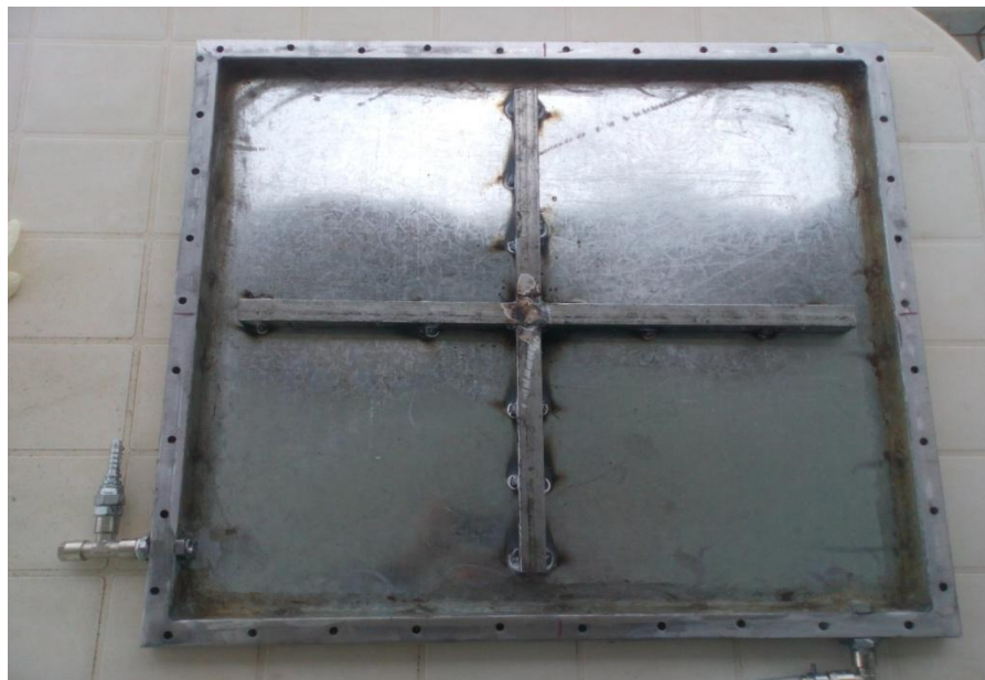
(Εικόνα 45) Τοποθέτηση κατασκευής σχήματος σταυρού εντός του θερμικού συλλέκτη
