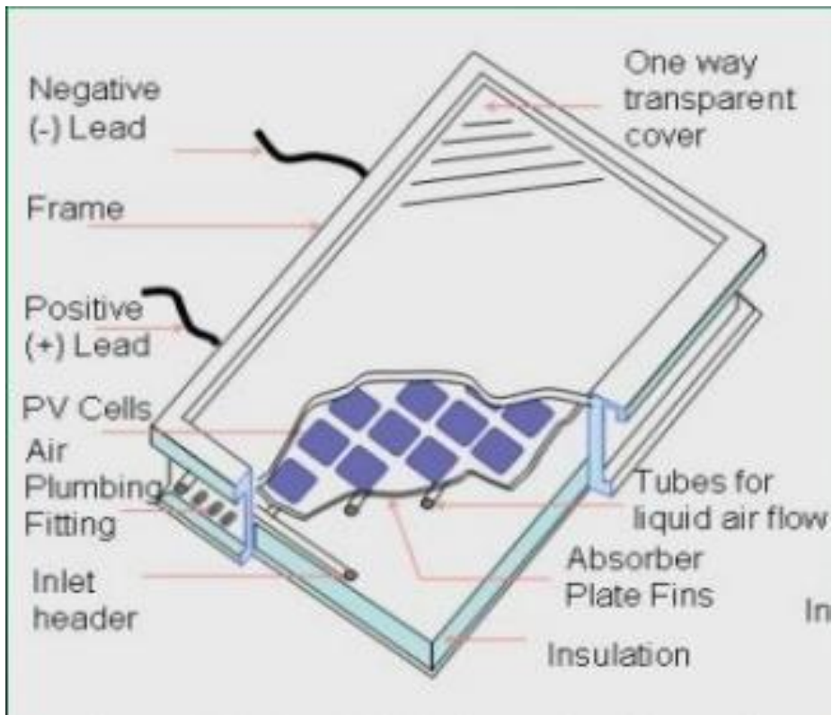
(Εικόνα 18) Γραφική απεικόνιση υβριδικού φωτοβολταϊκού/θερμικού συστήματος με ρευστό
