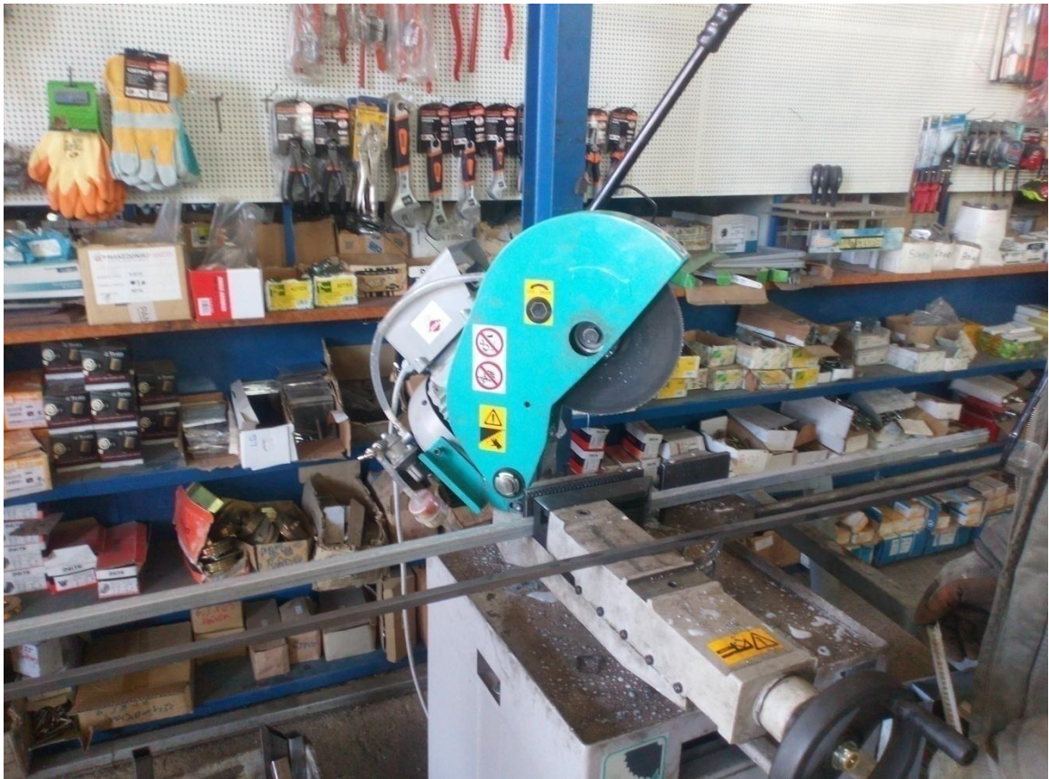
(Εικόνα 35) Σταθερός τροχός κοπής μετάλλων υπό γωνία 45°
