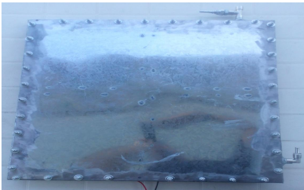
(Εικόνα 46) Τελική συναρμολόγηση του θερμικού συλλέκτη με το φωτοβολταϊκό πάνελ
