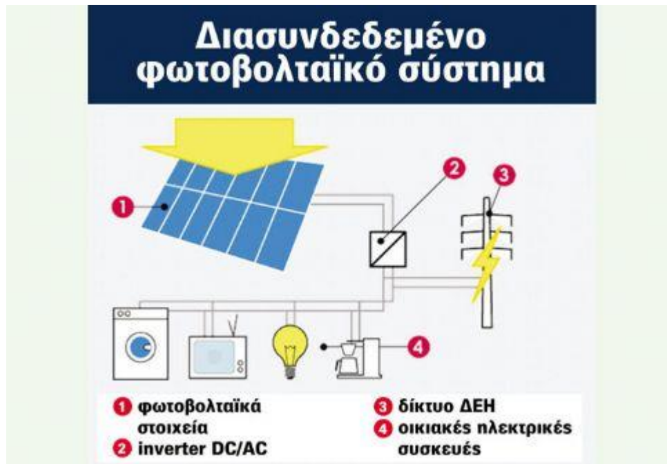
(Εικόνα 11) Βασικά μέρη διασυνδεδεμένου φωτοβολταϊκού συστήματος
