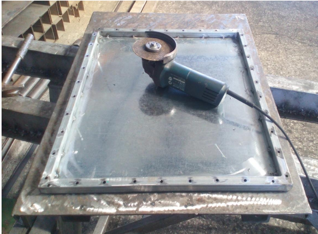
(Εικόνα 36) Τροχός κοπής και λείανσης μετάλλων χειρός
