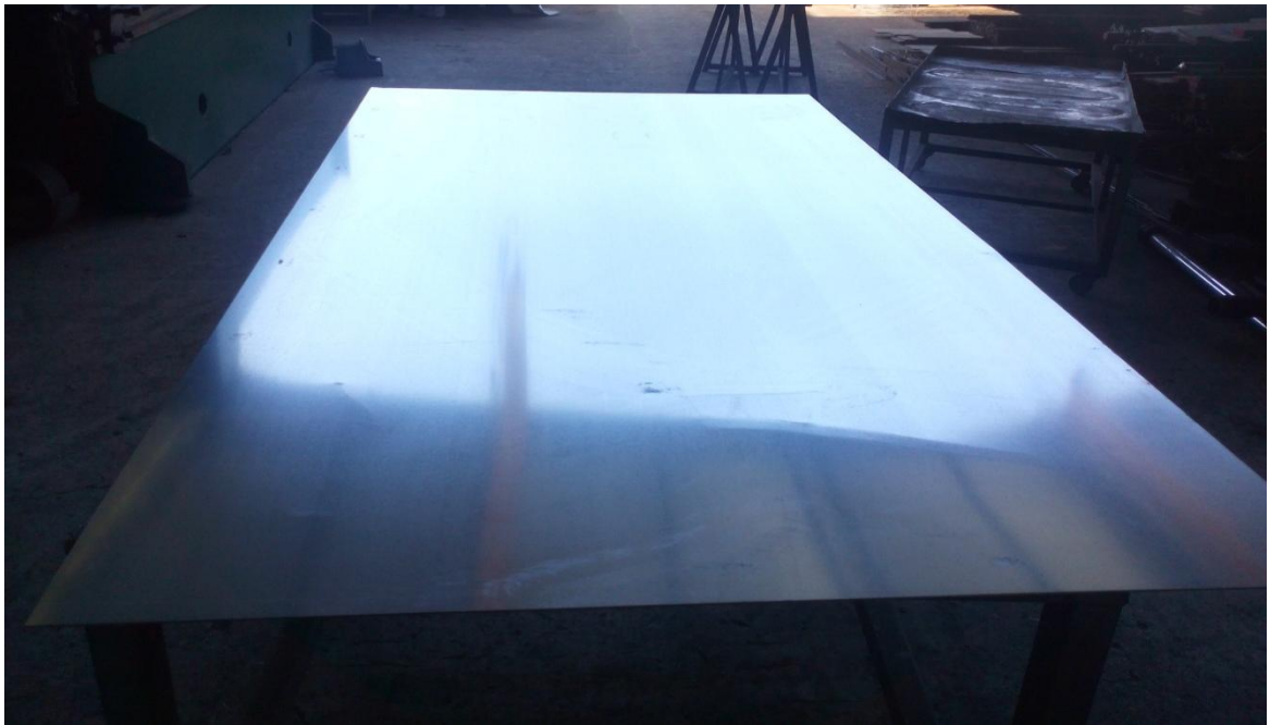
(Εικόνα 32) Φύλλο λαμαρίνας γαλβάνιζε πάχους 1mm που χρησιμοποιήθηκε
