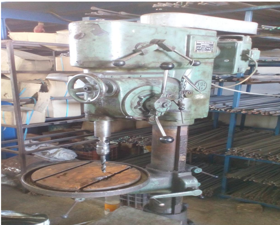
(Εικόνα 39) Κάθετο τρυπάνι σταθερών στροφών
