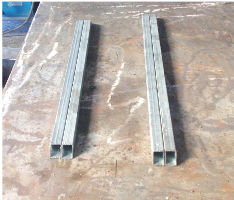
(Εικόνα 33) Πηγάκια τετράγωνα γαλβάνιζε διαστάσεων 20x20mm και πάχους 1,5mm
