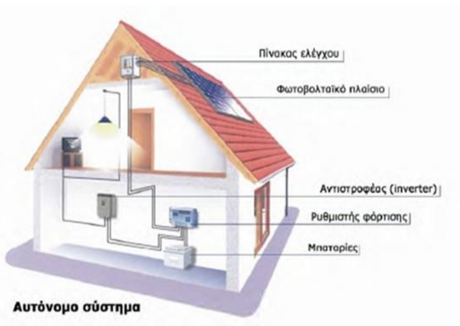
(Εικόνα 10) Αυτόνομο φωτοβολταϊκό σύστημα ενσωματωμένο σε κτίριο
