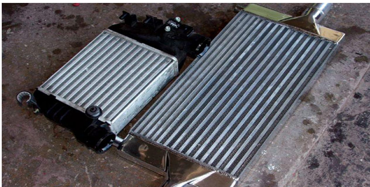
Συμπαγείς εναλλάκτες-ψυγεία αυτοκινήτων
