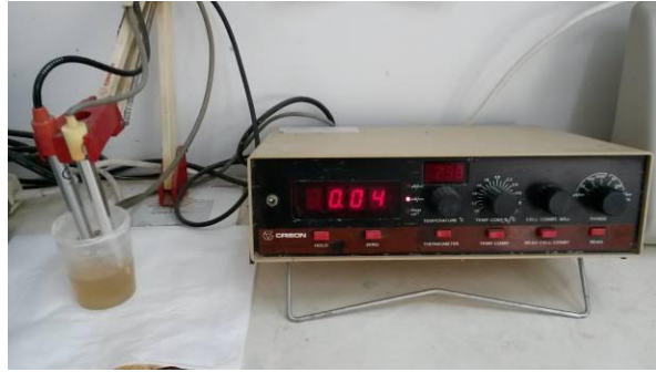
Εικόνα 3-19. Αγωγιμόμετρο εργαστηρίου ΤΕΙ Κρήτης
