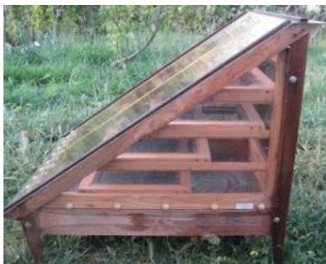
Εικόνα 2: Άμεσο ηλιακό ξηραντήριο με δίσκους αποξήρανσης
