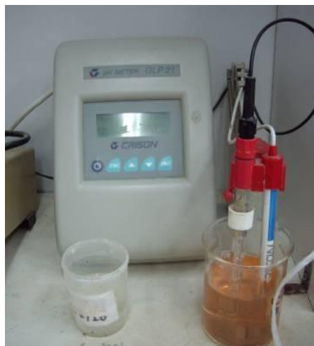
Εικόνα 3-18. Πεχόμετρο εργαστηρίου ΤΕΙ Κρήτης
