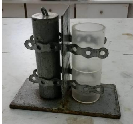
Εικόνα 3-16. Εξοπλισμός που χρησιμοποιείται για την επίτευξη κορεσμού των δειγμάτων. Χαρακτηριστικά κάτω κολίνδρου, εσωτ. Διάμετρος 42mm και ύψος 58mm ( 80\text{cm}^3 ) και βαρίδιο για τη συμπίεση των δειγμάτων
