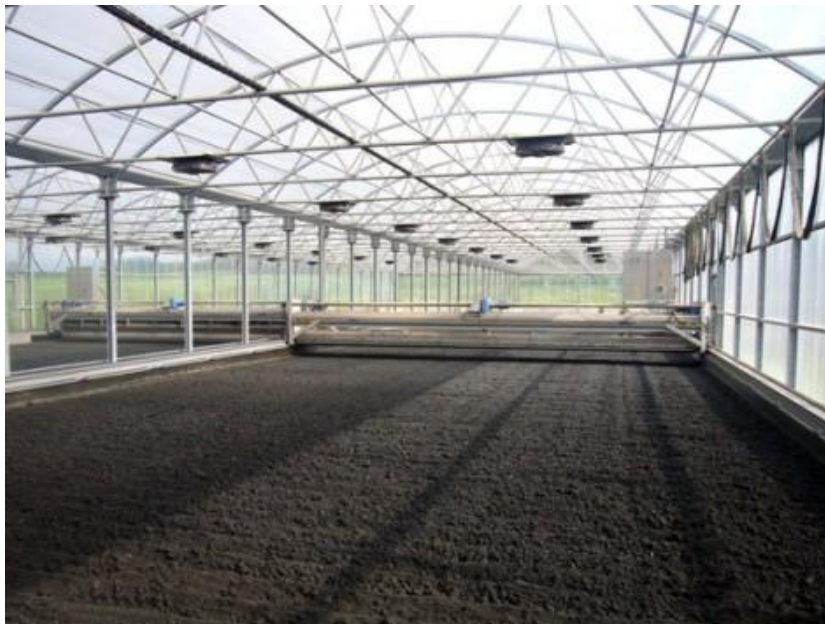
Εικόνα 3: Ενδεικτική εικόνα ξήρανσης ιλύος σε θερμοκήπιο με χρήση μηχανολογικού εξοπλισμού
