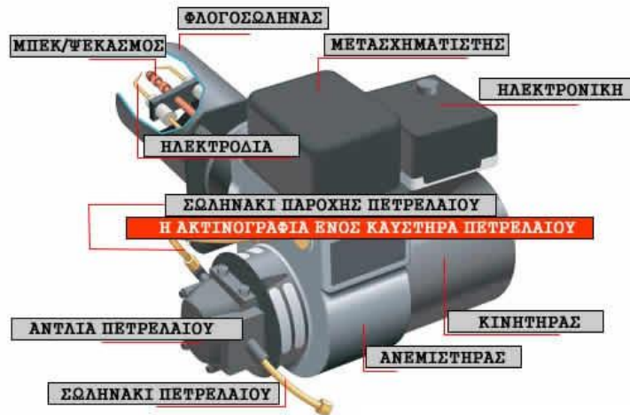
Εικόνα 97:Τα μέρη του καυστήρα
