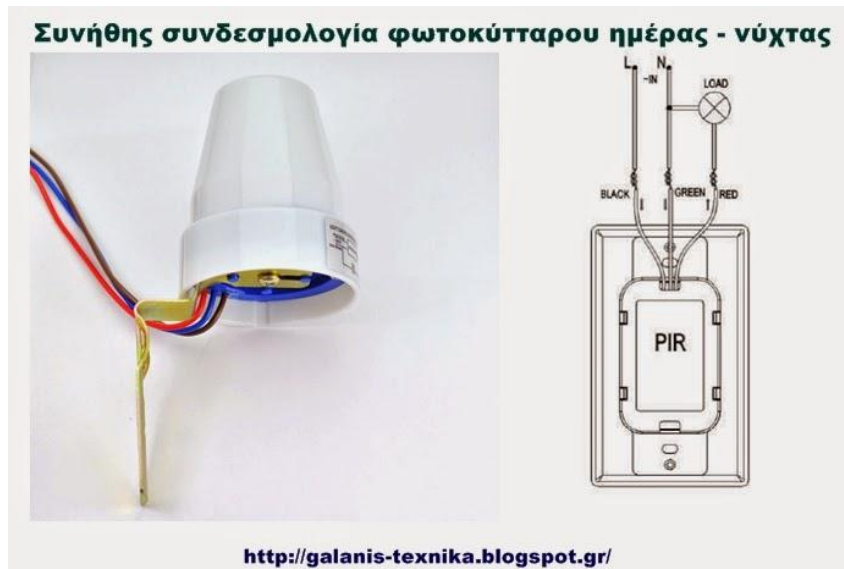
Εικόνα 57:Συνδεσμολογία φωτοκύτταρου ημέρας- νύχτας
