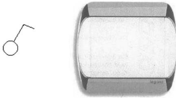
Εικόνα 44: Απλός διακόπτης και το ηλεκτρολογικό του σύμβολο
