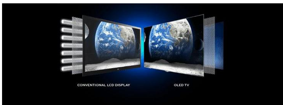
Εικόνα 48 Κατασκευαστική διαφορά σε τεχνολογία LCD και OLED τεχνολογία
