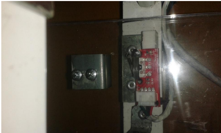
ΕΙΚΟΝΑ 82: τερματικός διακόπτης άξονα Y με το stop
