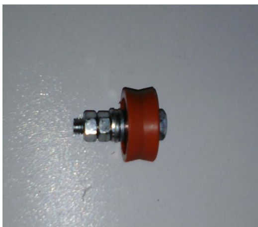
ΕΙΚΟΝΑ 55: ράουλο που χρησιμοποιήθηκε στον εκτυπωτή
