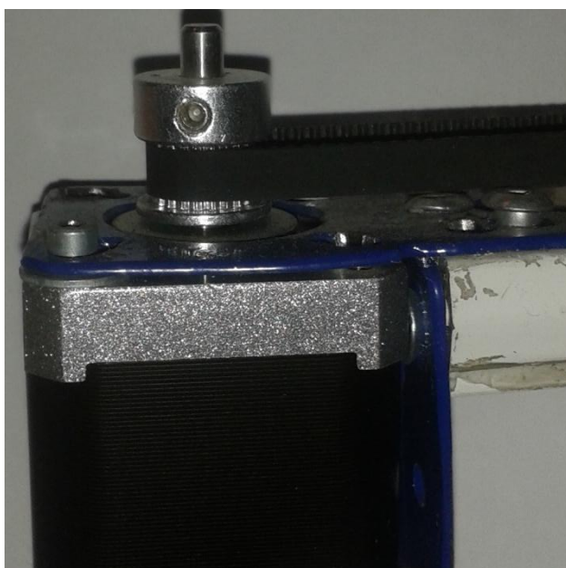
ΕΙΚΟΝΑ 83: κινητήρας άξονα Y με pulley gear και ιμάντα
