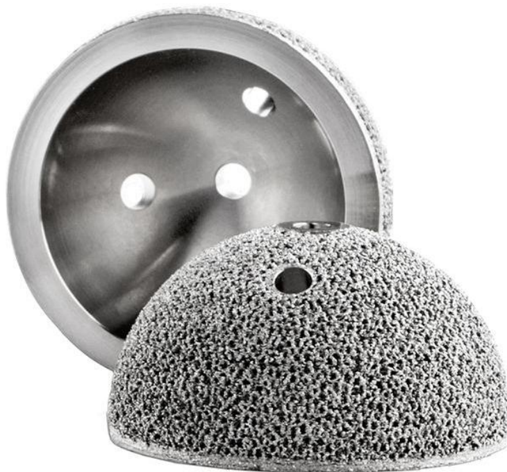
ΕΙΚΟΝΑ 12: δοκίμιο κατασκευασμένο με την μέθοδο EBM
