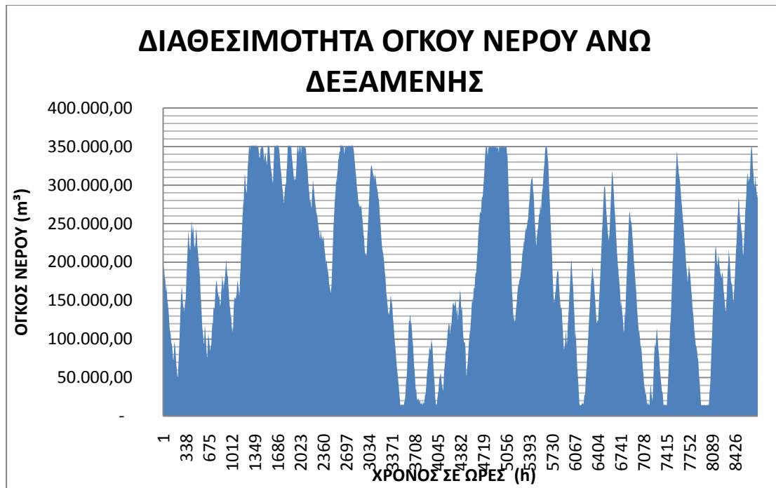
Σχήμα 4.26 : Απεικόνιση παραμένουτος όγκου νερού στη δεξαμενή
