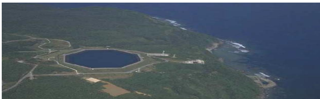
Εικόνα2.9: Αεροφωτογραφία του έργου. Διακρίνεται η υδροληψία, ο άνω ταμιευτήρας και οι οδοί προσπέλασης.
