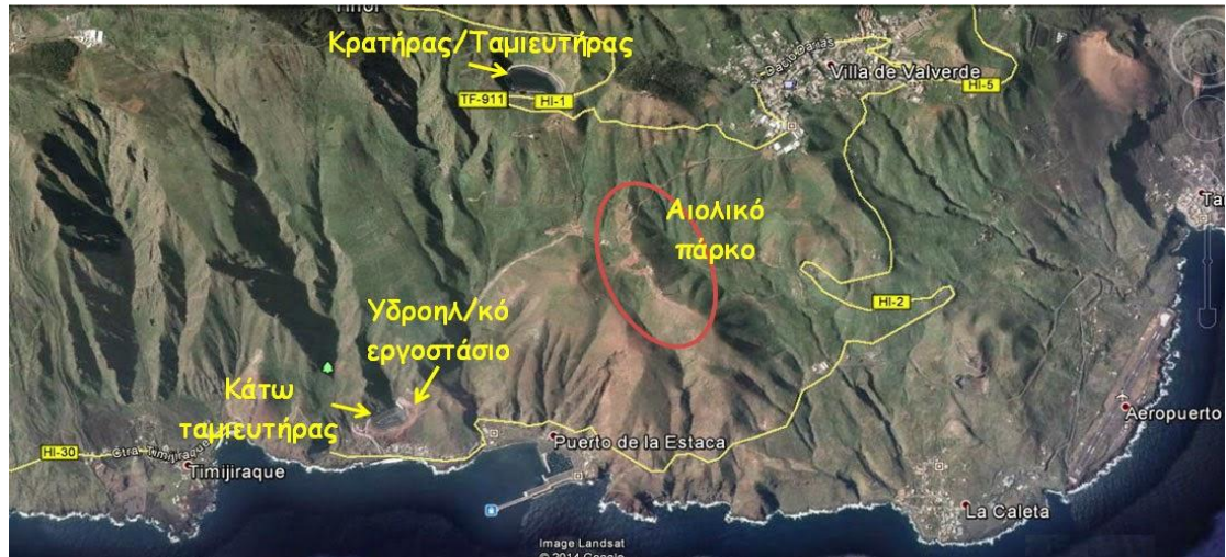
Εικόνα2.7: Χαρτογραφημένη διάταξη του υβριδικού σταθμού
