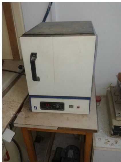
Εικόνα 4.3: Τοποθέτηση δειγμάτων στους 550°C για 2h.
