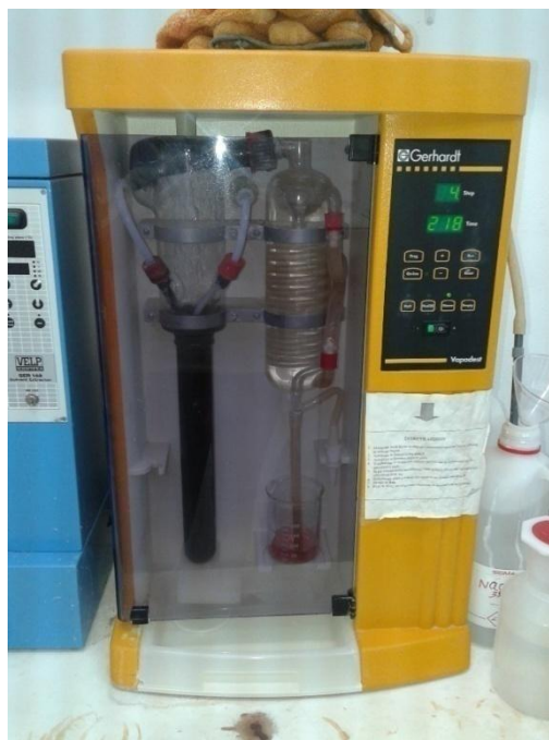
Εικόνα 4.6: Σύστημα απόσταξης Varodest.
