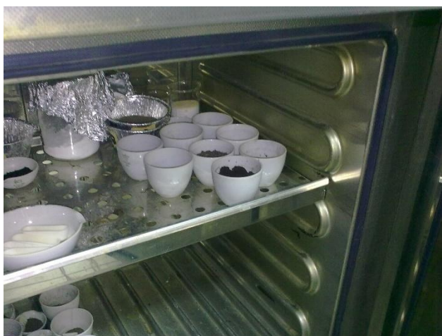
Εικόνα 4.4: Τοποθέτηση δειγμάτων στους 105°C για 24h.
