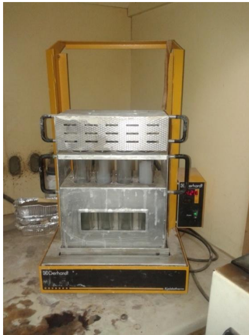
Εικόνα 4.5: Μηχάνημα της πέψης(Kjeldahl Digestion Instrument)
