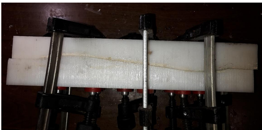
Σχήμα 9-8 Καλούπι Ασφαλισμένο με Σφιγκτήρα
