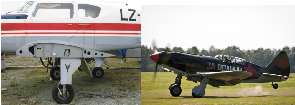
Σχήμα 7-7 Αριστερά: Clark YH ρίζα πτέρυγας ενός Yak-18T. Δεξιά Mig-3 Πολεμικό αεροσκάφος 2 ου Παγκοσμίου πολέμου που χρησιμοποίησε Clark Y αεροτομή.
